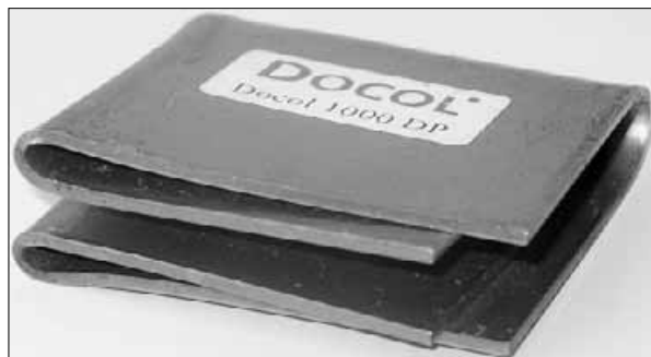
Rys. 1 Półka ze stali Docol o minimalnej granicy plastyczności R_e=1000\text{MPa} zginana na zimno. Promień zginania jest co najwyżej dwukrotnie większy od grubości blachy
