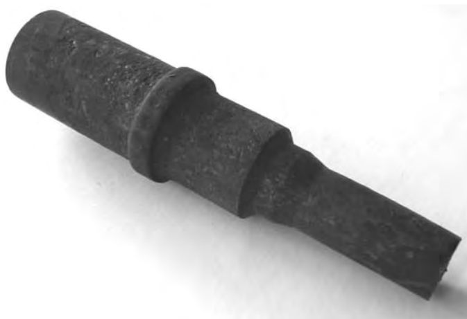
Rys. 7.67. Odkuwka wałka sprzęgła uzyskiwana w procesie WPK, realizowanego narzędziami pokazanymi na rys. 7.64
