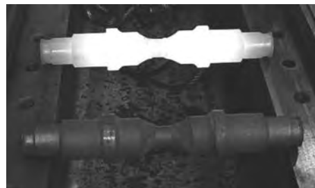
Rys. 7.25. Odkuwki korpusów noży obrotowych, otrzymane w pierwszym wariantcie walcowania
