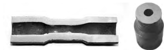
Rys. 11.32. Przekroje odkuwki drążonej, ze stali C45, wykonanej z wsadu o grubości ścianki g_0 = 0,25d_0
