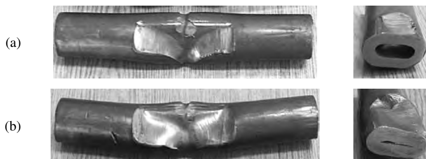
Rys. 8.23. Próbki zdeformowane w efekcie wystąpienia niekontrolowanego poślizgu, przy: a) d_w = 18 mm; b) d_w = 15 mm ( \delta = 1,36 , \alpha = 30^\circ , \beta = 10^\circ – w obu przypadkach)
