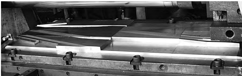
Rys. 7.61. Narzędzia klinowe, do walcowania odkuwki sprzęgła (w układzie podwójnym), zabudowane w walcarce SP-IH 2000
