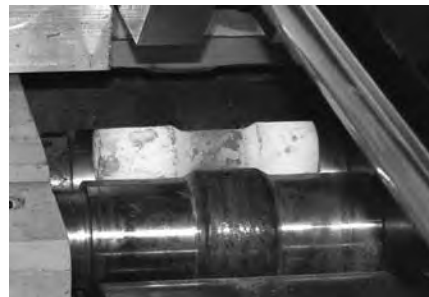
Rys. 11.29. Próbką ze stali C45 po walcowaniu na gorąco, realizowanym zgodnie ze schematem 5
