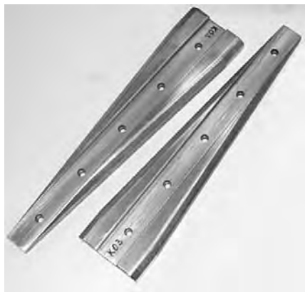
Rys. 8.5. Narzędzia klinowe zapewniające odwalcowanie dwóch przewężeń
