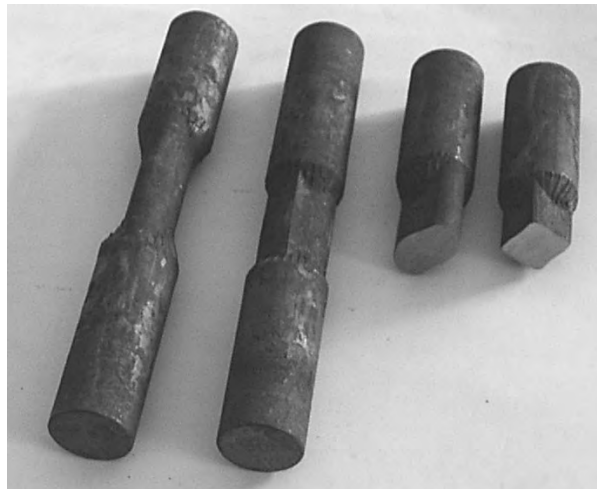
Rys. 9.40. Odkuwki ze stopniami kształtowymi (owalnym i kwadratowym) otrzymanymi w procesie WPK
