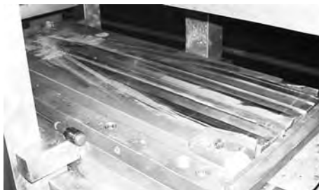
Rys. 7.24. Klin dolny (w wersji pierwszej), zamontowany w walcarce przemysłowej, przygotowany do prób walcowania
