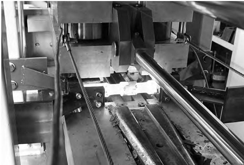
Rys. 4.5. WPK na gorąco odkuwki ze stali C45, w walcierce laboratoryjnej LUW-2
