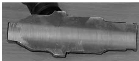
Rys. 7.29. Widok przekroju wzdłużnego (osiowego) odkuwki odwalcowanej w wariacie drugim
