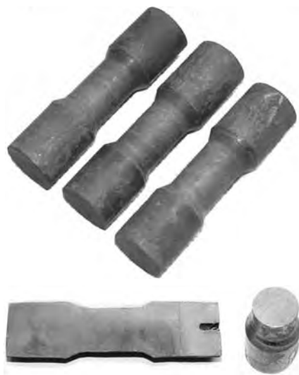
Rys. 11.30. Próbkę ze stali C45, w widoku i przekrojach, ukształtowane w procesie WKR wg schematu 5
