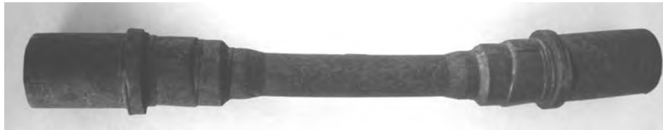
Rys. 7.62. Odkuwki wałka sprzęgła, po procesie WPK realizowanego narzędziami pokazanymi na rys. 7.58
