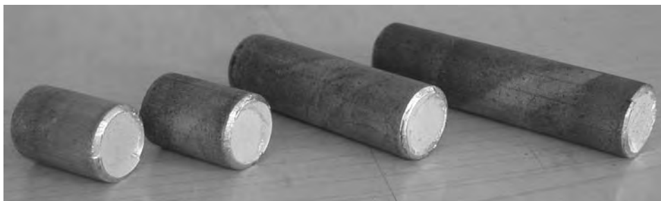
Rys. 10.23. Odcinki pręta ze stopu EN AW-ALMg4 otrzymane w procesie dzielenia bezodpadowego, realizowanego przy: \alpha = 45^\circ , \theta = 2^\circ , \Delta r = 2 mm (łamanie zachodziło, gdy długość próbki przekraczała 130% wartości jego średnicy)
