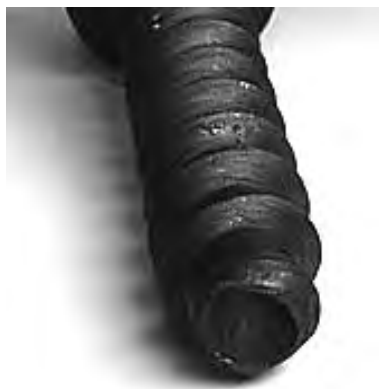
Rys. 9.3. Zakończenie części gwintowanej wkręta, wykonanej metodą walcowania trzema rolkami
