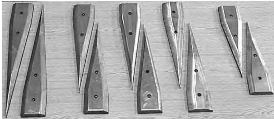
Rys. 8.4. Zestawy segmentów narzędziowych stosowane w badaniach doświadczalnych procesów WPK odkuwek drażnionych
