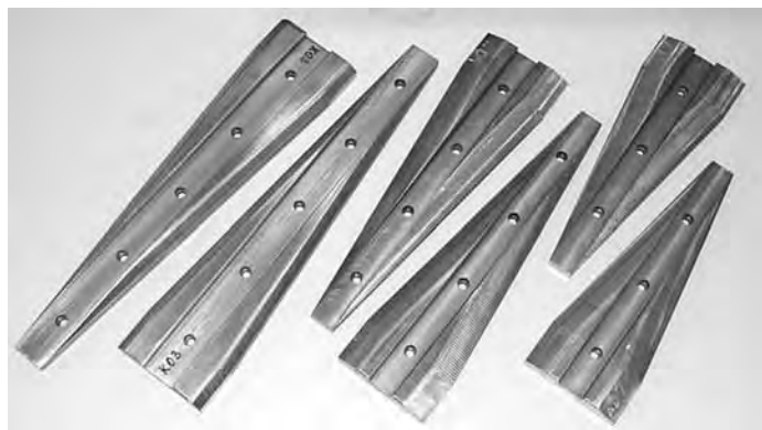
Rys. 4.2. Kliny zastosowane w badaniach doświadczalnych, mających na celu wyznaczenie sił kształtowania
