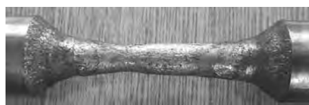
Rys. 8.24. Przewężenie centralnej części wyrobu odnotowane w procesie WPK przy \delta = 1,67 , \alpha = 30^\circ , \beta = 8^\circ , d_w = 12 mm
