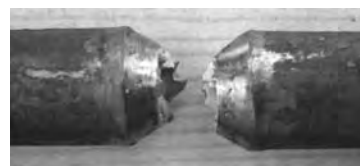
Rys. 10.19. Zerwanie próbki walcowanej przy: \alpha = 40^\circ , \gamma = 1^\circ , \Delta r = 3,5 mm, d_0 = 17,8 mm
