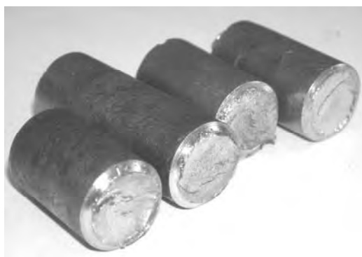
Rys. 10.24. Odcinki pręta ze stopu MO59 otrzymane w procesie dzielenia bezodpadowego, realizowanego przy: \alpha = 60^\circ , \theta = 2^\circ , \Delta r = 2 mm
