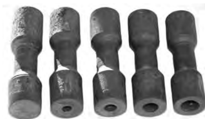
Rys. 11.31. Przykłady próbek ze stali C45 odwalcowanych w procesie WKR przy: \alpha = 30^\circ , \beta = 5^\circ , d_0 = 25 \text{ mm} , d = 17,2 \text{ mm} , h_k = h_R = 5 \text{ mm} oraz licząc od prawej d_n wynoszącym 15,0 mm, 12,5 mm, 10,0 mm i 7,5 mm
