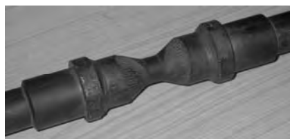
Rys. 7.30. Niedowalcowania widoczne na stożkowej powierzchni korpusów noży odwalcowanych w wariacie drugim
