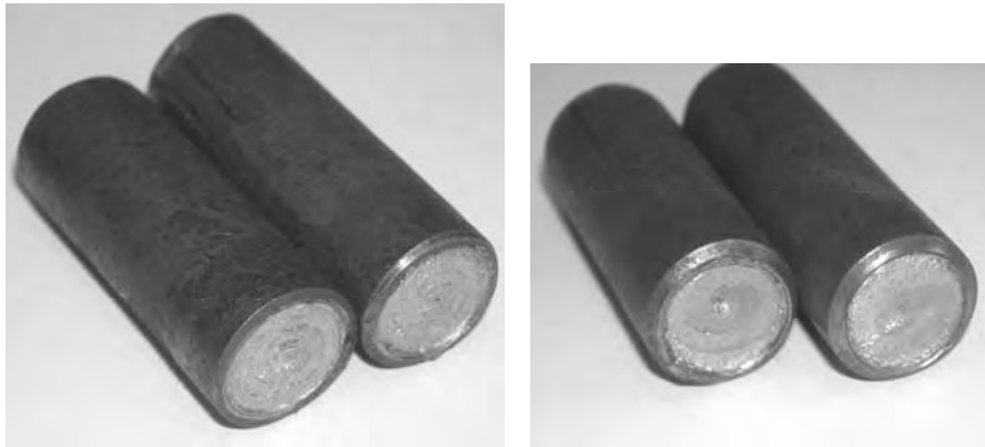
Rys. 10.25. Odcinki pręta ze stali C45 otrzymane w procesie dzielenia bezodpadowego, realizowanego przy: \alpha = 45^\circ , \Delta r = 2 mm oraz \theta = 2^\circ (rys. z lewej) oraz \theta = 3^\circ (rys. z prawej)
