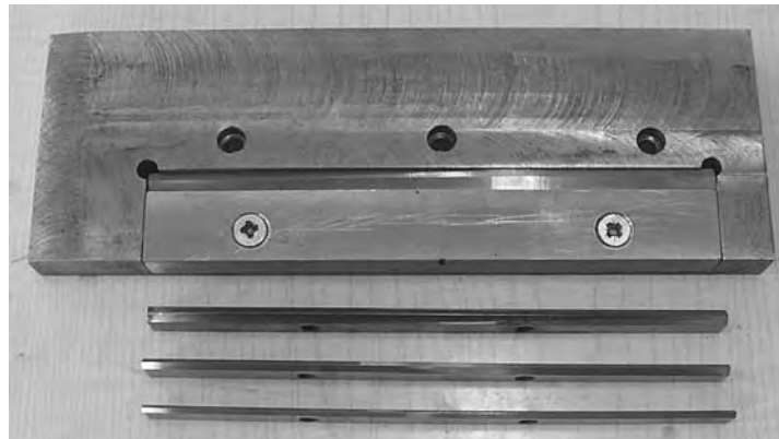
Rys. 10.3. Segment narzędziowy zastosowany w badaniach doświadczalnych WKR na zimno
