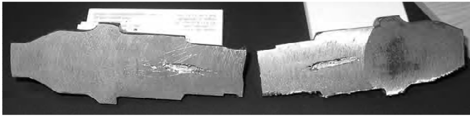
Rys. 7.26. Pęknięcia osiowe, widoczne w przekrojach wzdłużnych odkuwek walcowanych wg wariantu pierwszego
