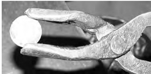
Rys. 7.56. Kula S \varnothing 25 mm, odwalcowana w badaniach laboratoryjnych
