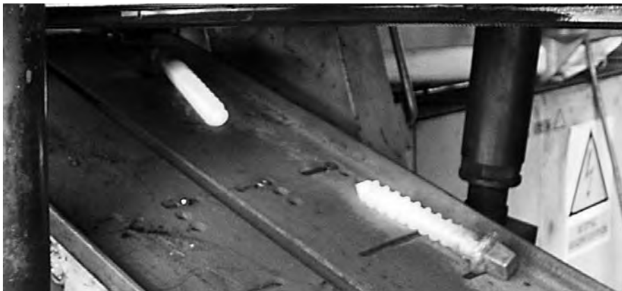
Rys. 9.23. Proces walcowania wkrętów w układzie podwójnym: odkuwka z nagrzaną częścią środkową, ułożona w narzędziach walcujących (rys. górny); spadające do pojemnika wyroby po walcowaniu (rys. dolny)
