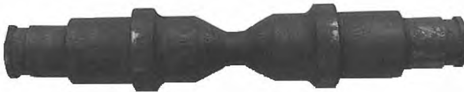
Rys. 7.34. Fotografia próbki odwalcowanej w wersji czwartej, w której wyeliminowano niedowalcowania w części środkowej
