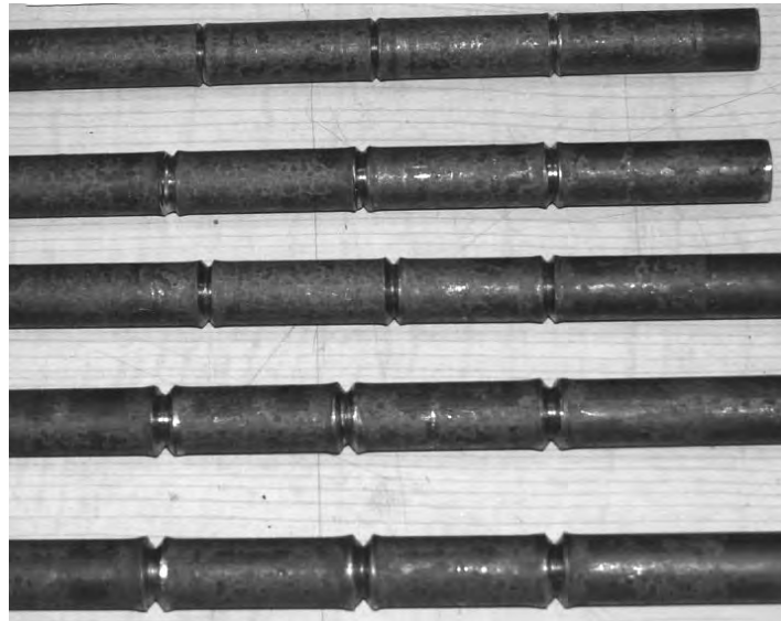
Rys. 10.4. Próbkki z rowkami w kształcie litery V otrzymanymi w procesach WPK przy: \alpha = 50^\circ oraz \Delta r = 1,0; 1,6; 2,0; 2,6 i 2,9 mm (kolejno od góry)
