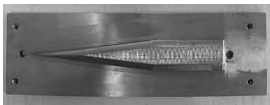
Rys. 11.7. Segment klinowy o kącie rozwarcia klina 7^\circ , zastosowany w badaniach WKR na rolkach gładkich
