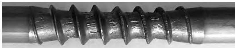
Rys. 9.17. Odkuwka z gwintem, odwalcowana narzędziami KO1 z wsadu o średnicy d_0 = 22 mm
