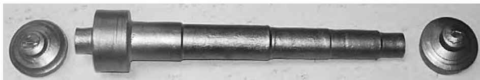
Rys. 7.48. Odkuwka wałka pośredniego odwalcowana, w czasie prób warsztatowych, narzędziami w stanie miękkim
