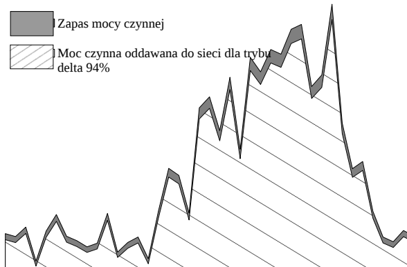
Rys. 3. Charakterystyka zmienności mocy czynnej w funkcji czasu dla FW przy zadanym delta 94% (drugi wariant badań)
