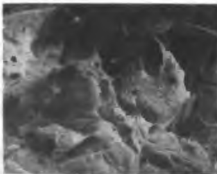
Rys. 9.5.11. Przełom próbki po austenitzowaniu przy 950^{\circ}\text{C}/\text{min} . i chłodzeniu w wodzie. Mikroskop skaningowy. Pow. \times 1000
