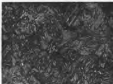
Rys. 9.5.13. Mikrostruktura stali 20H2M po austenitzowaniu przy 900^{\circ}\text{C}/90 min. i chłodzeniu w wodzie oraz po odpuszczaniu przy 500^{\circ}\text{C}/5 godz., pow. \times 500
