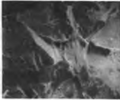
Rys. 9.5.17. Przełom próbki po hartowaniu i odpuszczaniu przy temperaturze 400°C. Pow. x1000
