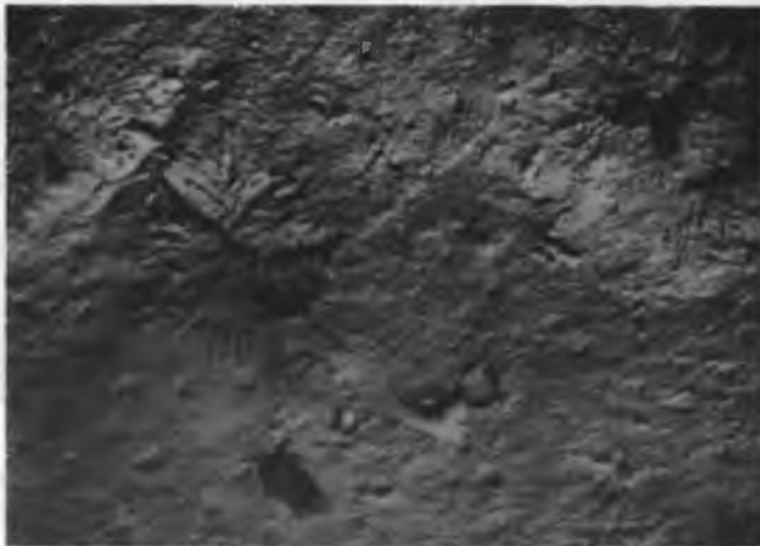
Rys. 8.10. Widok struktury elementu wymiennika ciepła po ok. 6 m-cach pracy w strefie wierzchniej odległej o 1,5 mm od powierzchni. Żeliwo ciągliwe czarne o osnowie ferrytyczno-perlitycznej. Mikroskop elektronowy, replika węglowa x9600
