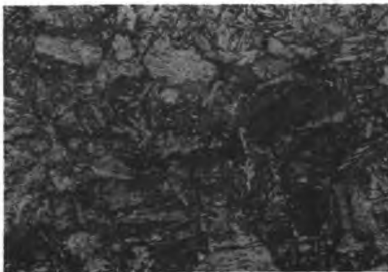
Rys. 9.5.14. Mikrostruktura stali 20H2M po austenityzowaniu przy 900°C/90 min. i chłodzeniu w wodzie oraz po odpuszczaniu przy 700°C/5 godz., pow. x500
