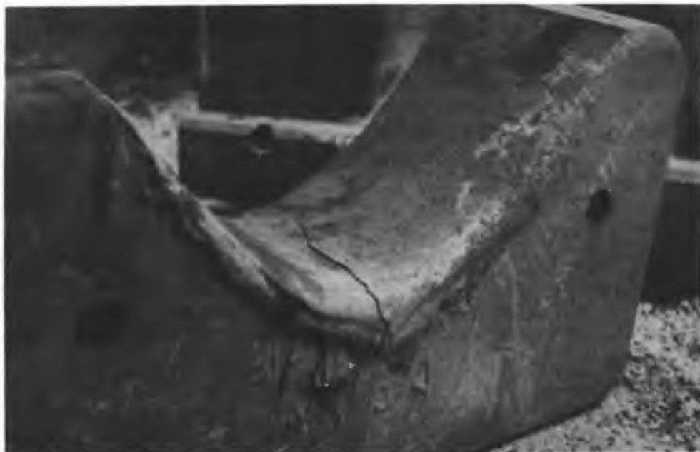
Rys. 9.3.1. Widok pękniętego kowadła do kucia swobodnego na prasie o nacisku 2000 t
