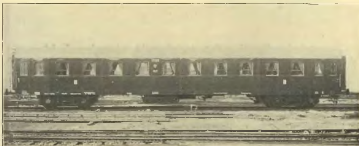
Wagon osobowy III kl. konstrukcji żelaznej, budowy fabr. H. Cegielski S. A. Poznań.
