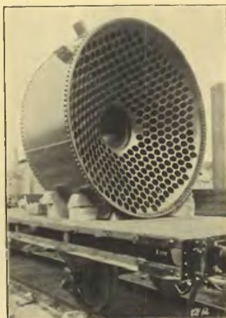
Komora o dnach słózkowych do wyparki cukru.
