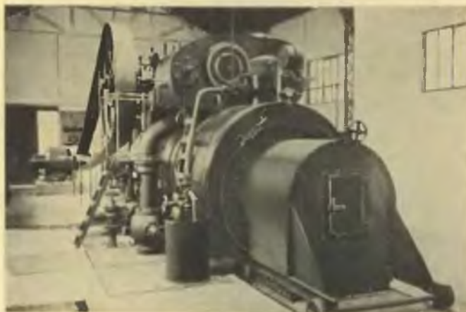
Lokomobila stacyjna z przedpaleniskiem.
