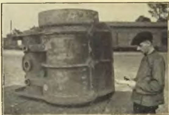
Cylinder parowozowy — odlew.
