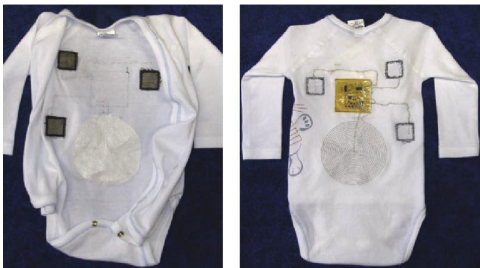
Rys. 14. Dziecięcy kombinezon z umieszczonym na nim aparatem do pomiaru EKG [13]
