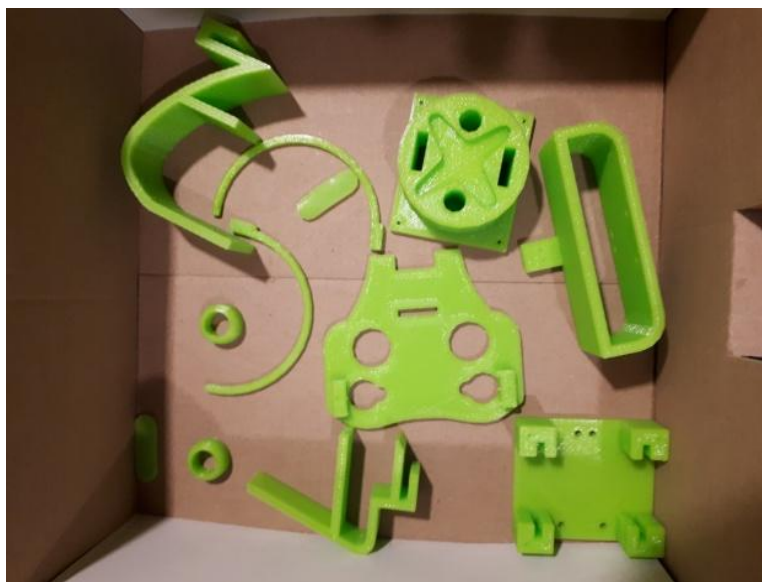
Rys. 11. Części głowy robota wydrukowane z tworzywa PET
