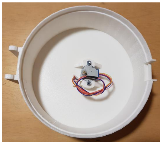
Rys. 8. Zamocowany do podstawy silnik krokowy
