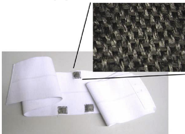
Rys. 12. Elastyczny pas z elektrodami materiałowymi [13]
