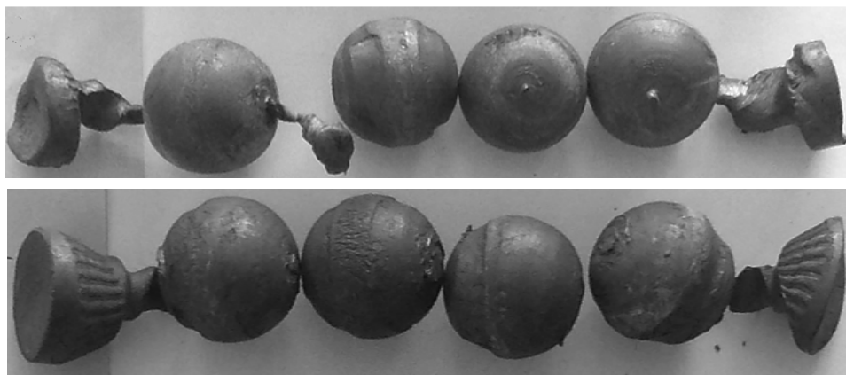
Rys. 4.23. Odkuwki kul ze stali kolejowej R200 (szyna), otrzymane w procesie WPK metodą zwykłą
