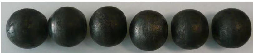
Rys. 5.30. Kule otrzymane w procesie walcowania poprzecznego, wykonanego w warunkach GFN Sp. z o.o. w Radzynie Podlaskim
