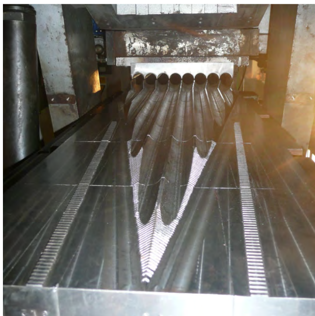
Rys. 5.9. Narzędzia klinowe do WPK 8 kul S\varnothing 35 mm, zamontowane w walcarce SP2000
