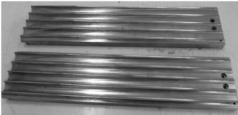
Rys. 4.28. Widok narzędzi stosowanych w procesie WPK kul metodą ze spęczaniem
