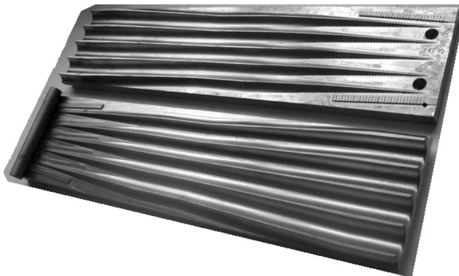
Rys. 4.25. Widok narzędzi stosowanych w procesie WPK kul metodą równoległą
