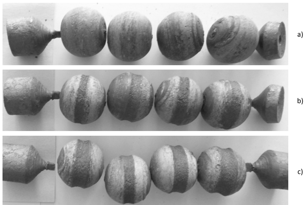
Rys. 4.29. Odkuwki kul ze stali R200, otrzymane w procesie WPK metodą ze spęczaniem: a) ze wsadu o średnicy \varnothing 18 mm, b) ze wsadu o średnicy \varnothing 17,5 mm, c) ze wsadu o średnicy \varnothing 17 mm
