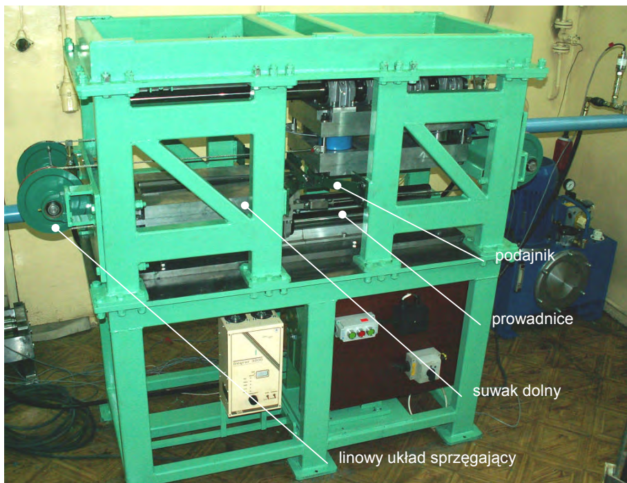
Rys. 4.3. Walcarka laboratoryjna LUW-2, pracująca w układzie dwóch przemieszczających się przeciwnie klinów płaskich
