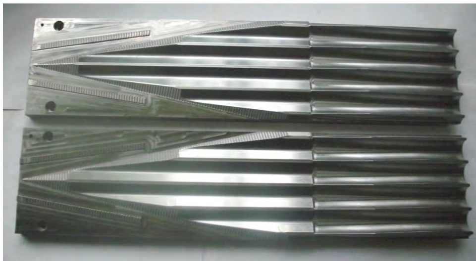
Rys. 4.22. Widok narzędzi stosowanych w procesie WPK kul metodą zwykłą
