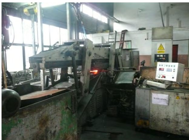
Rys. 5.1. Gniazdo walcarki płaskoklinowej SP 2000, znajdujące się w GFN w Radzynie Podlaskim
