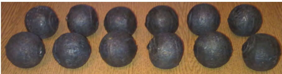
Rys. 5.20. Półwyroby kul \varnothing 35 mm, otrzymane w procesie WPK w układzie 6 sztuk
