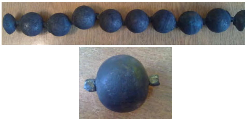
Rys. 5.10. Kule odwalcowane w walcarce SP2000, w układzie 8 sztuk
