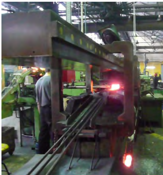
Rys. 2.21. Projekt wirtualny (u góry) oraz prototyp (u dołu) walcarki płaskoklinowej wykonanej w jednym z zakładów przemysłowych w Polsce
