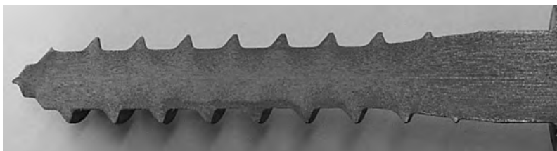
Rys. 2.14. Widok przekroju osiowego wkręta szynowego otrzymanego w procesie WPK
