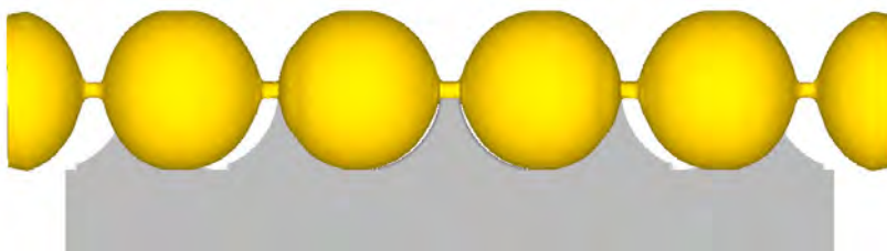
Rys. 3.53. Kształt kul (w widoku w kierunku walcowania) otrzymanych w procesie WPK przedstawionym na rysunku 3.52
