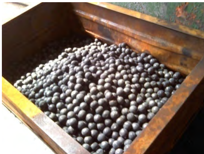
Rys. 5.33. Partia próbna półwyrobów kul, odwalcowana w warunkach GFN w Radzynie Podlaskim
