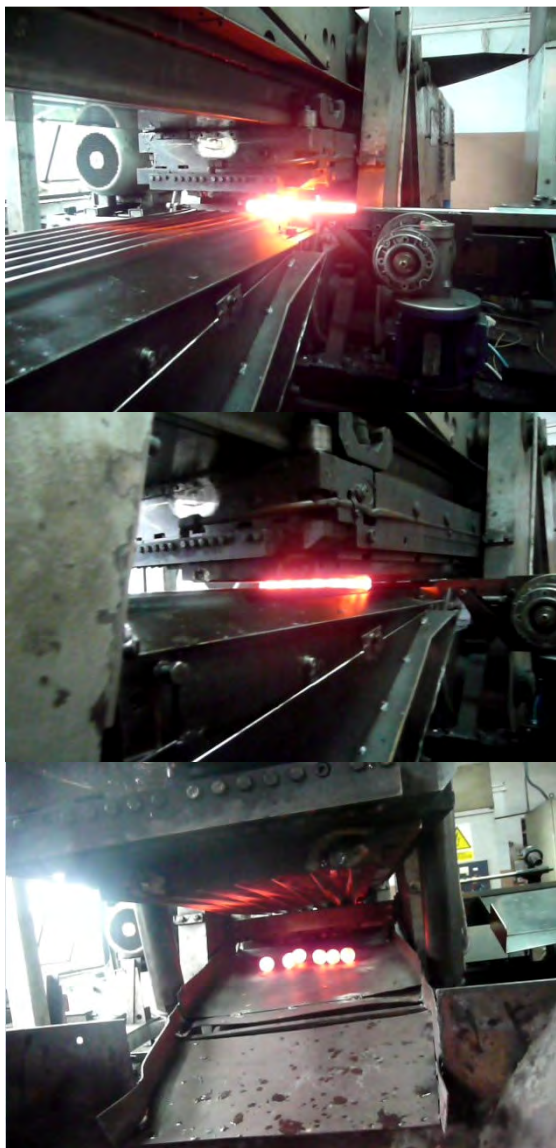
Rys. 5.29. Etapy walcowania poprzecznego 6 kul: wprowadzanie wsadu; kształtowanie; półwyroby kul staczające się do zbiornika z wodą (kolejno od góry)
