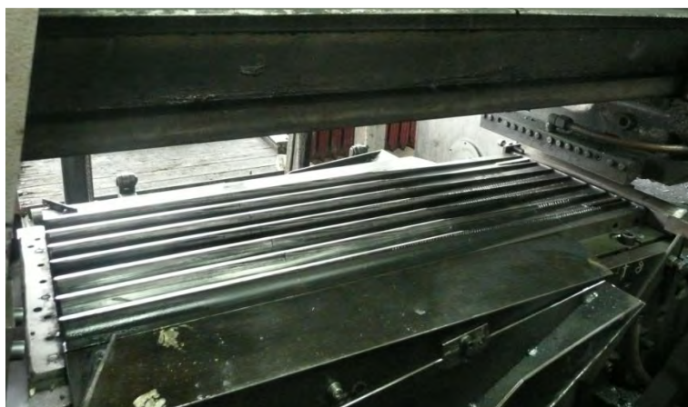
Rys. 5.28. Widok dolnego (nieruchomego) narzędzia służącego do walcowania poprzecznego 6 kul jednocześnie
