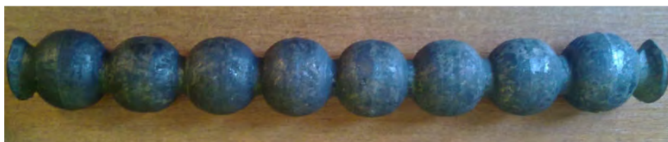
Rys. 5.11. Półwyroby kul odwalcowane narzędziami pozbawionymi noży rozcinających, służących do rozdzielania kul
