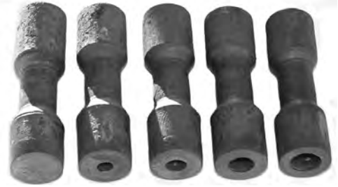
Rys. 2.8. Przykłady półwyrobów stalowych otrzymanych w próbach kształtowania metodą WKR
