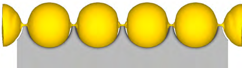
Rys. 3.49. Kształt kul (w widoku w kierunku walcowania) otrzymanych w procesie WPK przedstawionym na rysunku 3.48
