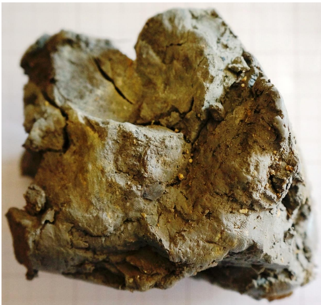
Fot. 8.2. Próba gliny Pawłów w naturalnej formie, w stanie powietrzno-suchym
