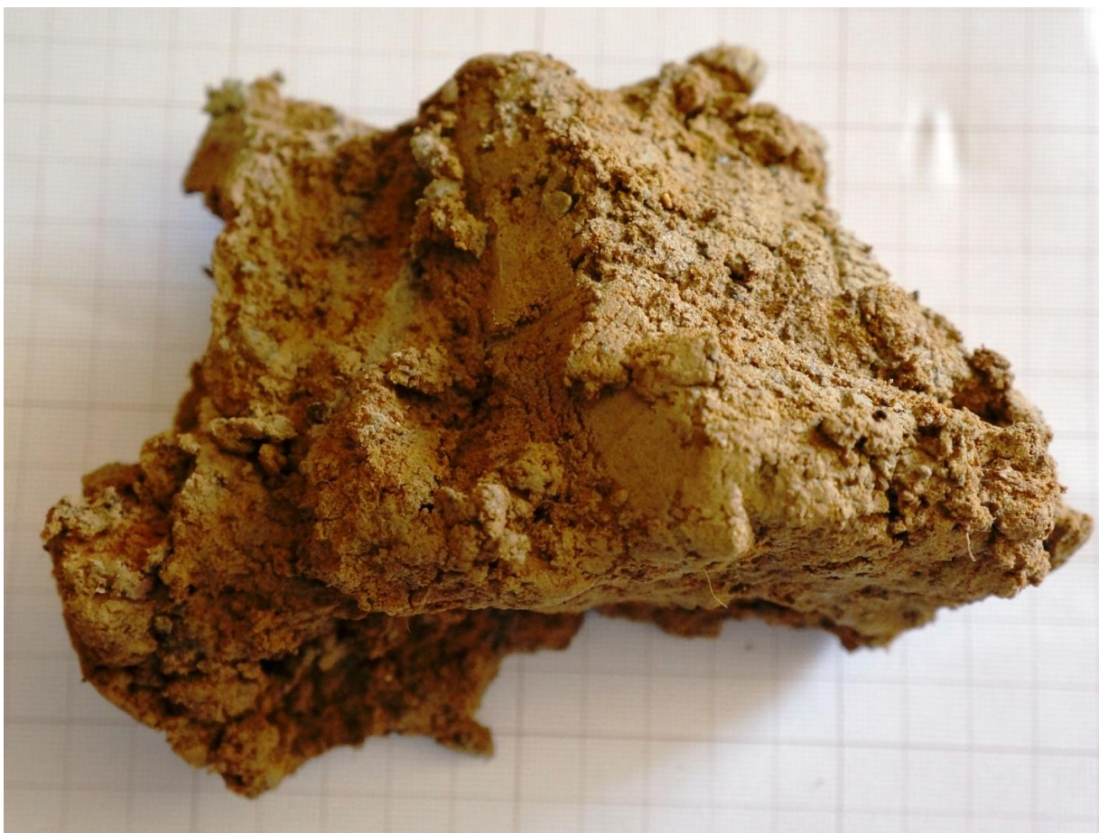
Fot. 7.2. Próba gliny Mejznerzyn w naturalnej formie, w stanie powietrzno-suchym
