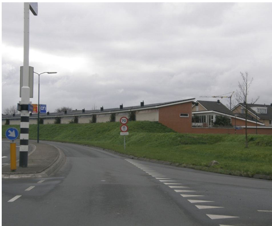
Rys. 5.17. Przykład zabudowy osłaniającej osiedle mieszkaniowe w Holandii – garaże z dodatkowym wałem ziemnym i ograniczeniem prędkości
