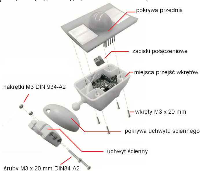
Rys. 5. Budowa czujnika pogodowego WES/A 1.1
