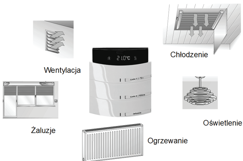
Rys. 7. Sterowanie kilkoma funkcjami w pomieszczeniu za pomocą jednego sensora Źródło: Materiały informacyjne ABB
