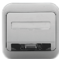
Rys. 12. Łącze szeregowe RS 232 oraz jego symbol graficzny
