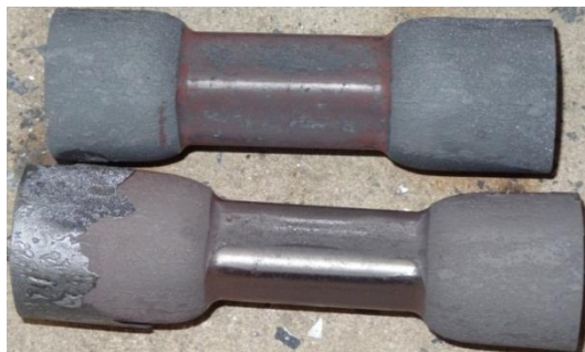
Rys. 5.27. Deformacja obciskanego stopnia odkuwki zaobserwowana podczas kształtowania półfabrykatów z małymi prędkościami ( g_0 = 3 mm, v/D = 1,6 mm/s, \delta = 1,5 )
