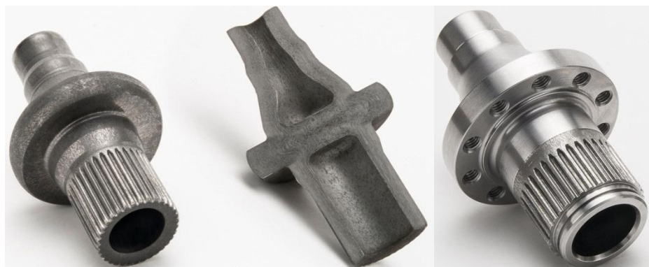
Rys. 2.48. Drążona odkuwka wałka kształtowana na zimno [170]
