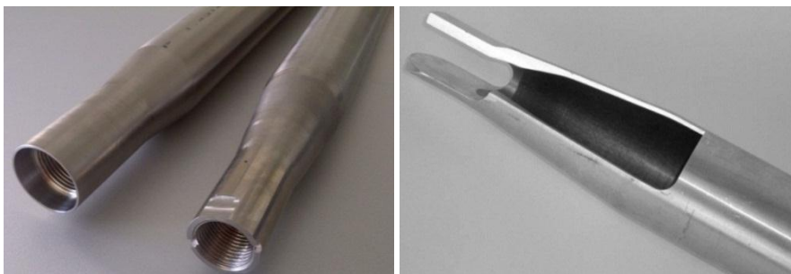
Rys. 2.23. Odkuwki drążone kute w kowarkach w warunkach firmy Heinrich Müller Maschinenfabrik GmbH [171]
