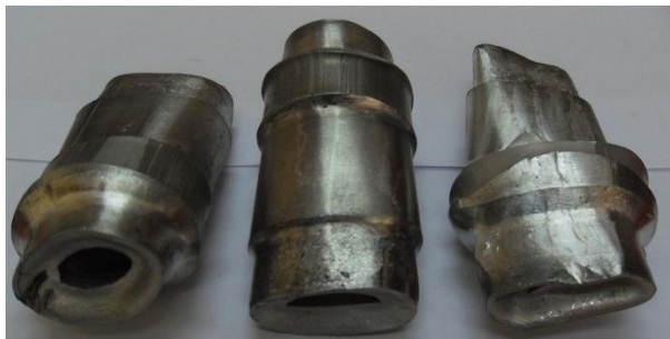
Rys. 7.13. Zdeformowane w wyniku silnej owalizacji podczas obciskania obrotowego odkuwki ze stopu aluminium 2618A
