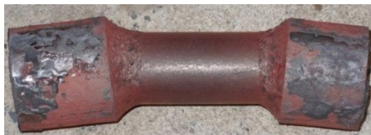
Rys. 5.26. Wygięcie osi obciskanej odkuwki, spowodowane brakiem podparcia skrajnych stopni podczas kształtowania wyrobu
