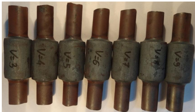
Rys. 5.14. Odkuwki elementarnych wałków ukształtowane z różnymi prędkościami narzędzi ( D = 38 \text{ mm} , g_o = 5 \text{ mm} , v = 3 \div 9 \text{ mm/s} , \delta = 1,5 )
