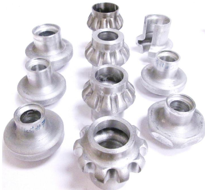
Rys. 2.40. Przykładowe elementy drążone wykonane zmodyfikowaną metodą kształtowania hydromechanicznego [4]
