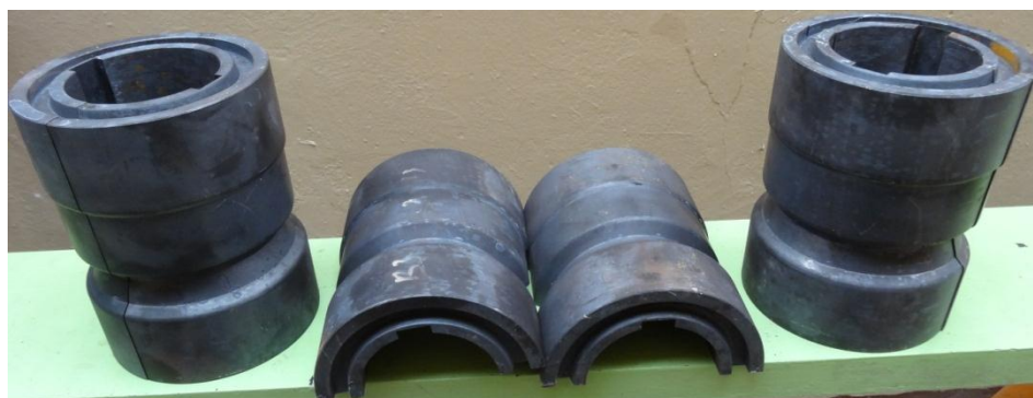
Rys. 7.8. Segmenty narzędziowe wykorzystane do obciskania drążonych odkuwek wałków napędowych
