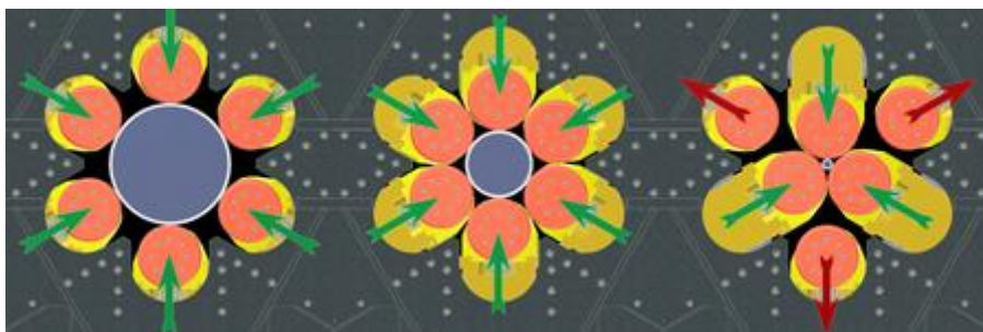
Rys. 2.7. Położenie rolek kształtujących w maszynach do zgniatania obrotowego firmy Repkon [178]
