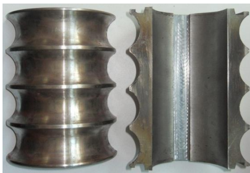
Rys. 7.31. Zestaw dzielonych segmentów narzędziowych do obciskania obrotowego odkuwek kul drążonych
