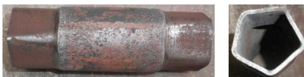
Rys. 5.17. Deformacja obciskanych na zimno stopni odkuwki, powstała w wyniku przyjęcia zbyt dużego gniotu ( g_o = 2,6 \text{ mm} , \delta = 1,2 )
