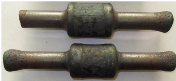
Rys. 5.13. Odkuwki obciskane dwuetapowo z międzyoperacyjnym dogrzewaniem materiału ( D = 42,4 mm, g_0 = 7 mm oraz 9 mm, \delta = 1,9 , v = 5 mm/s)
