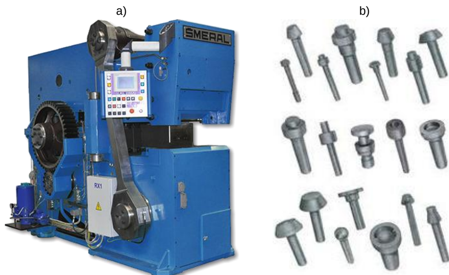
Rys. 2.32. Kuźniarka z poziomym podziałem matryc firmy Smeral – a) oraz przykładowe odkuwki kształtowane przy jej zastosowaniu – b) [181]
