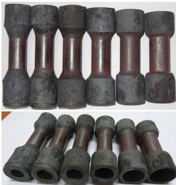
Rys. 5.25. Odkuwki elementarnych wałków ze środkowym przewężeniem ukształtowane z półfabrykatów rurowych o różnych grubościach ścianki ( D = 42,4 \text{ mm} , v/n = 5 \text{ mm/obr} , \delta = 1,5 )
