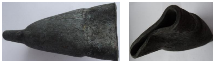
Rys. 5.10. Deformacja obciskanej odkuwki, wynikająca ze zbyt cienkiej ścianki wsadu ( v = 3 \text{ mm/s} , \delta = 1,5 )
