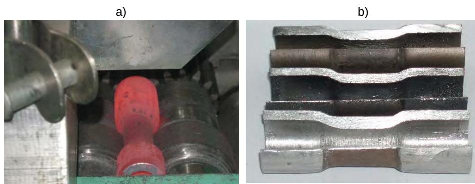
Rys. 2.55. Ukształtowane w procesie obciskania obrotowego odkuwki w układzie dwóch rolek podpierających oraz płaskiego narzędzia klinowego: a) bezpośrednio po procesie, b) drążone odkuwki ukształtowane odpowiednio ze stopu tytanu, stali i stopu aluminium [65]
