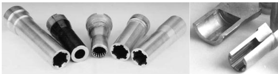
Rys. 2.52. Elementy kształtowane metodą spin extrusion [15, 23, 179]
