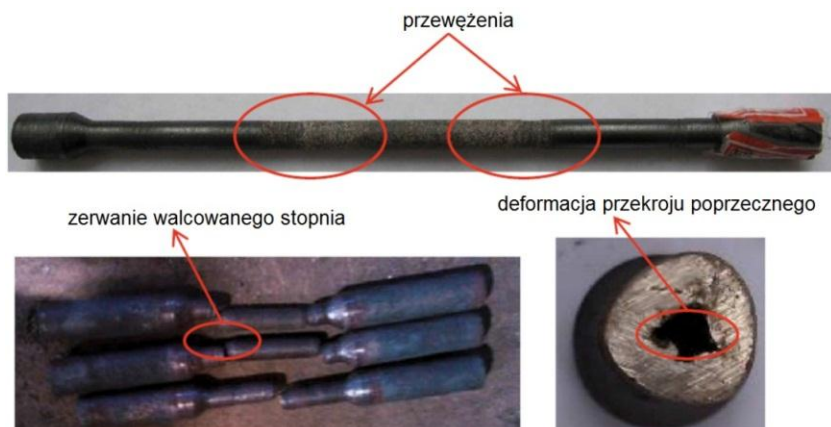
Rys. 2.13. Wady odkuwek drążonych kształtowanych w procesie WPK [46]
