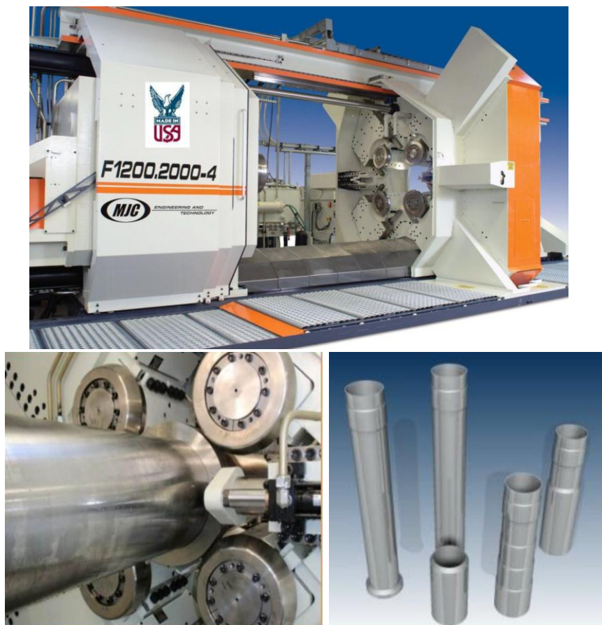
Rys. 2.6. Typowa maszyna do zgniatania obrotowego wydłużającego firmy MJC Engineering and Technology, Inc. oraz przykłady elementów w niej wytwarzanych [177]
