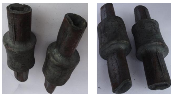
Rys. 5.12. Deformacja obciskanych stopni odkuwki, wywołana zamknięciem otworu i poślizgiem narzędzi ( v/n = 8 \text{ mm/obr} , \delta = 1,8 , g_o/D = 0,16 )
