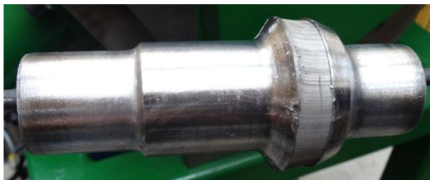
Rys. 7.14. Ukształtowana przedkuwka wałka drążonego ze stopu aluminium po pierwszym etapie obciskania obrotowego
