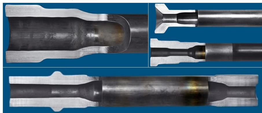
Rys. 2.33. Kształtowanie odkuwek drążonych metodą spęczania rur: a) wielozadaniowy agregat kuteńcy firmy GFU, b) schemat procesu, c) przykładowe odkuwki kute w agregacie [168]
