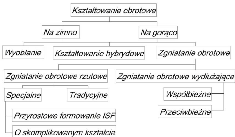
Rys. 2.1. Klasyfikacja procesów kształtowania obrotowego [40]
