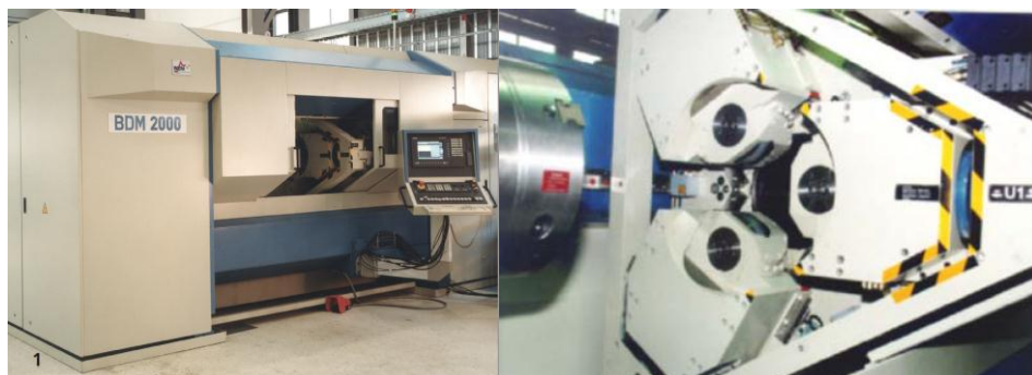
Rys. 2.51. Maszyna BDM 2000 do kształtowania wyrobów metodą spin extrusion [79]
