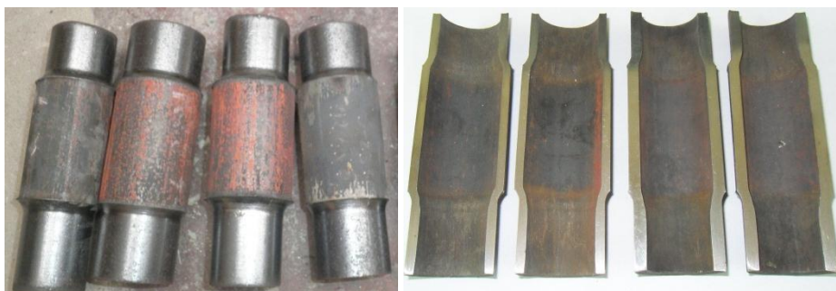
Rys. 5.16. Stalowe odkuwki drążonych wałków ze skrajnymi stopniami, obciskane na zimno
