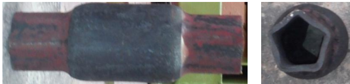
Rys. 5.11. Deformacja przekroju poprzecznego obciskanych stopni odkuwki, wynikająca z nadmiernego wychłodzenia materiału ( v = 1,0 \text{ mm/s} , \delta = 1,5 )
