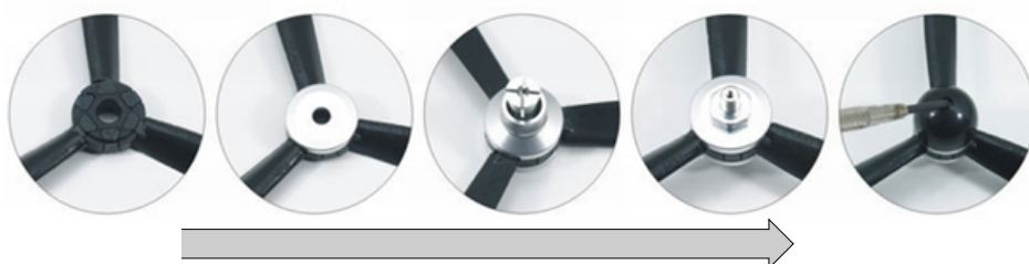
Rys. 3. Sposób montażu śmigieł w głowicy [4]
