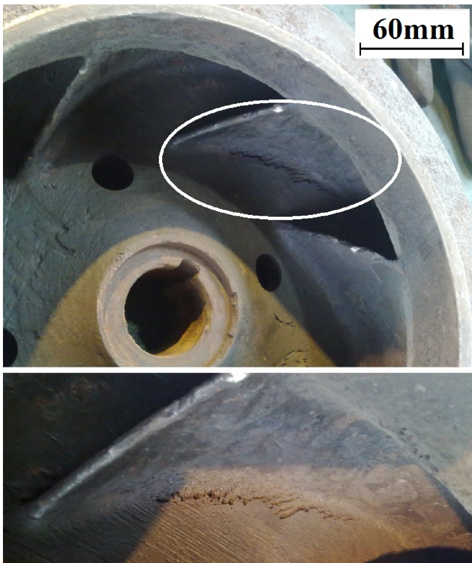
Rys. 7. Charakterystyczne dla zużycia kawitacyjnego uszkodzenie tarczy wirnika w pobliżu krawędzi wlotowych łopatek. Powiększony fragment przedstawia typową, chropowatą powierzchnię obszaru zużycia kawitacyjnego
