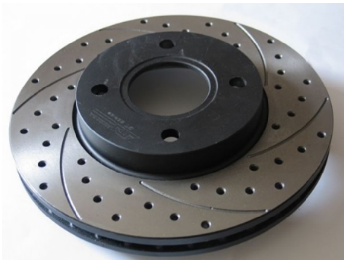
Rys. 4. Tarcza hamulcowa z widocznymi otworami i nacięciami mającymi za zadanie odprowadzanie ciepła z elementu [13]
