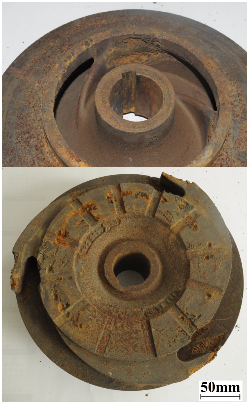
Rys. 8. Wirnik odśrodkowy o pojedynczej krzywiźnie łopatek. Uszkodzone kavitacyjnie: tylna ściana łopatki w pobliżu krawędzi wlotowej oraz tylna część tarczy, materiał żeliwo
