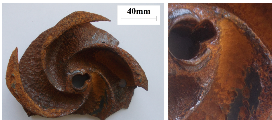
Rys. 11. Wirnik otwarty, uszkodzony na skutek oddziaływania erozji, korozji i kawitacji, dominuje zużycie erozyjne. Zużycie kawitacyjne lokalizowane na części ssawnej łopatek wirnika, materiał żeliwo
