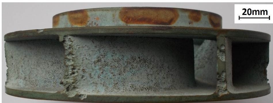
Rys. 10. Wirnik odśrodkowy o pojedynczej krzywiznie łopatek. Zużycie kawitacyjne krawędzi wylotowych łopatek wirnika, materiał brąz
