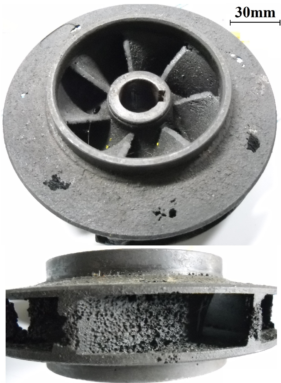
Rys. 9. Wirnik odśrodkowy o przestrzennej krzywiznie łopatek. Uszkodzone na skutek erozji kawitacyjnej powierzchnie tarcz wirnika oraz łopatki wirnika, materiał żeliwo
