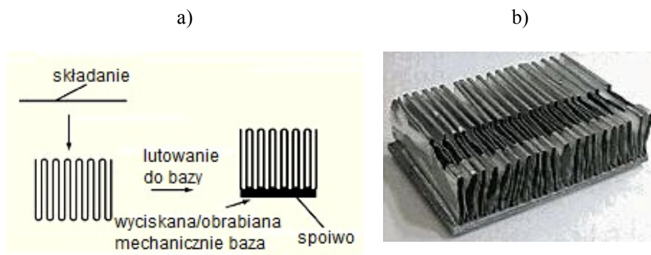
Rys. 8. Sposób wytwarzania radiatorów metodą składania: a) schemat procesu, b) ukształtowany radiator [10]
