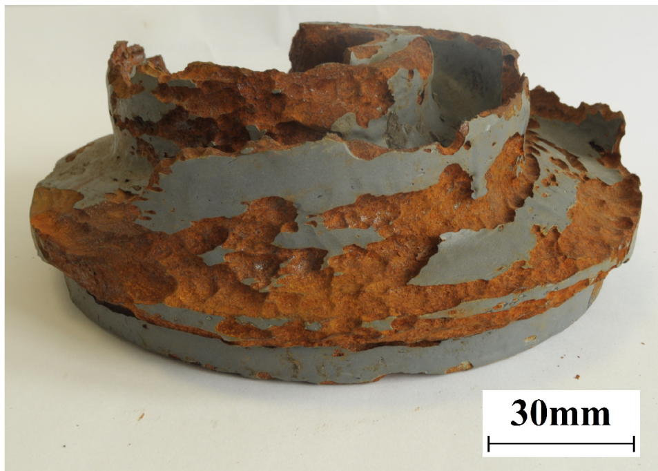
Rys. 10. Wirnik otwarty pompy wirowej z pokrytą powłoką epoksydową, uszkodzony na skutek oddziaływania erozji, korozji i kawitacji, materiał żeliwo
