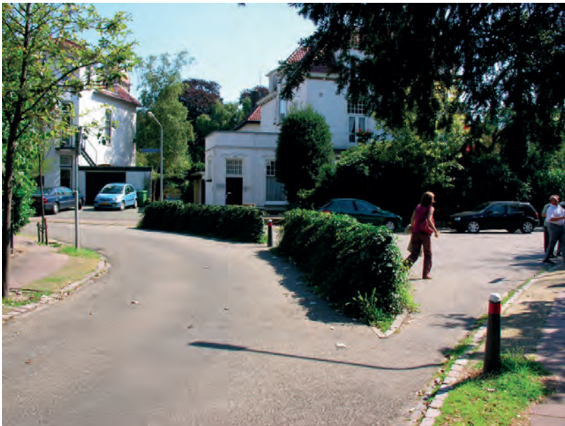
II. 22. Ograniczenie dostępności do obszaru pojazdom wielośladowym II. 22. The access restriction for an area for multi-track vehicles
