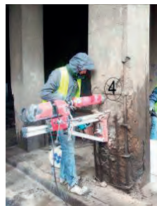
a) b) II. 24. Wiadukt nad ul. DMM a) widok z boku b) pobieranie próbek rdzeniowych do badań betonu, fot. SLK (1965).
