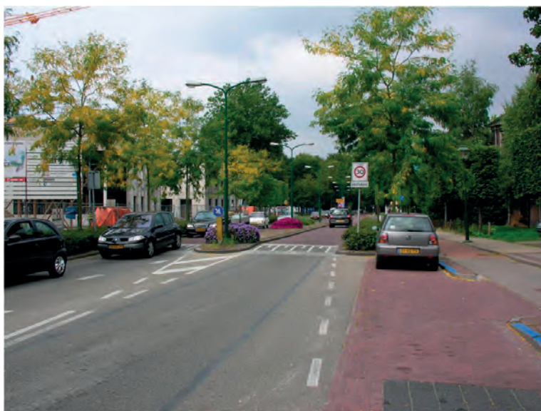
Il. 18. Zmiana przekroju drogi na granicy stref o różnej prędkości dopuszczalnej Il. 18. Change of the road cross-section at the border of the zones with different speed limits
