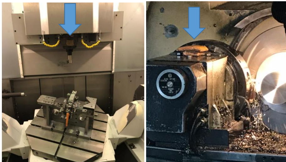
Rys. 45. Zamontowane i zabezpieczone czujniki Źródło: Opracowanie własne
