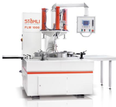
Rys. 1. Widok docierarki jednotarczowej FLM 1000 firmy Stähli (średnica zewnętrzna docieraka 750 mm, średnica wewnętrzna pierścienia prowadzącego 300 mm, prędkość obrotowa docieraka 70 \text{ min}^{-1} , dociążenie pneumatyczne elementów 50–1800 N, moc napędu głównego 4 kW) [8] i schemat układu wykonawczego (1 – rolka prowadząca, 2 – pierścień prowadzący, 3 – jarzmo, 4 – docierak) [1]
