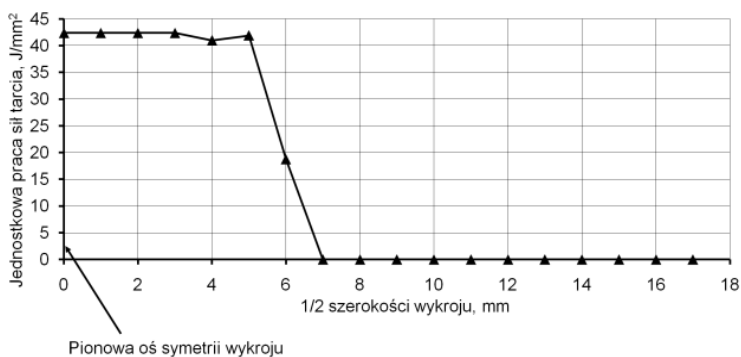
Rys. 4. Rozkład jednostkowej pracy sił tarcia na powierzchni walców w klatce 14: a) wykroj stosowany obecnie, b) nowy wykroj, 1/2 szerokości wykroju
