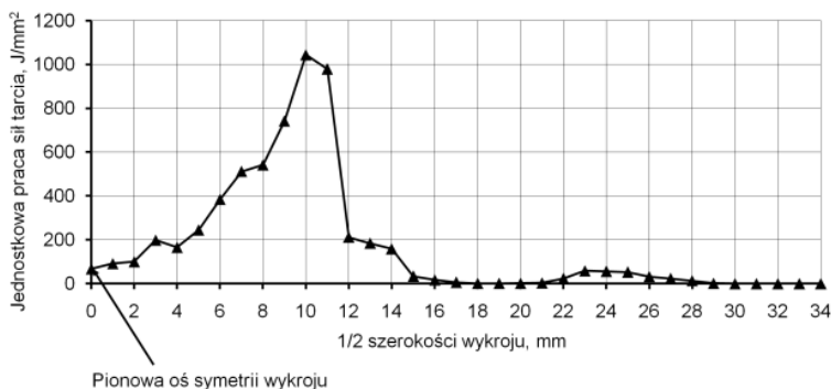
Rys. 5. Rozkład jednostkowej pracy sił tarcia na powierzchni wałców w klatce 15: a) wykroj stosowany obecnie, b) nowy wykroj, 1/2 szerokości wykroju
