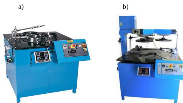
Rys. 3. Widok ogólny docierarki: a) Kemet 24 – średnica zewnętrzna tarczy docierającej 610 mm, prędkość obrotowa tarczy 59 min -1 , liczba pierścieni prowadzących 3, średnica wewnętrzna pierścienia prowadzącego 248 mm, moc napędu głównego 1,5 kW – dociążanie obciążnikowe elementów, b) obrabiarka z dociążaniem pneumatycznym elementów obrabianych [10]
