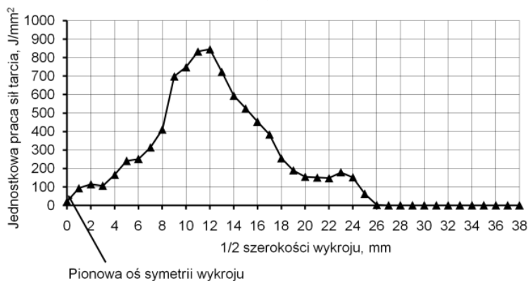
Rys. 3. Rozkład jednostkowej pracy sił tarcia na powierzchni walców w klatce 13: a) wykrój stosowany obecnie, b) nowy wykrój, 1/2 szerokości wykroju
