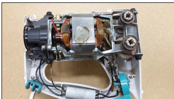
Rys. 6.2. Zastosowanie silnika komutatorowego w mikserze kuchennym
