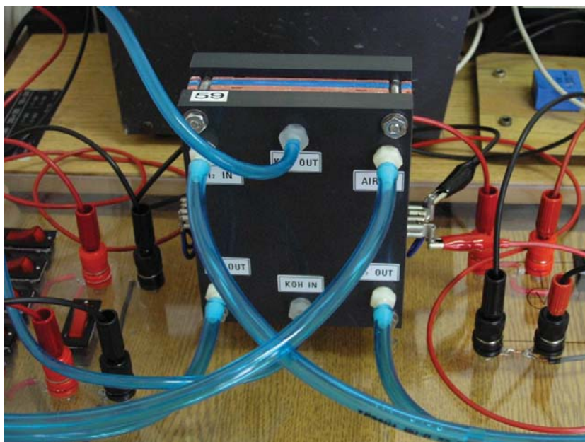
Rys. 8.4. Ogniw paliowe typu AFC na stanowisku badawczym
