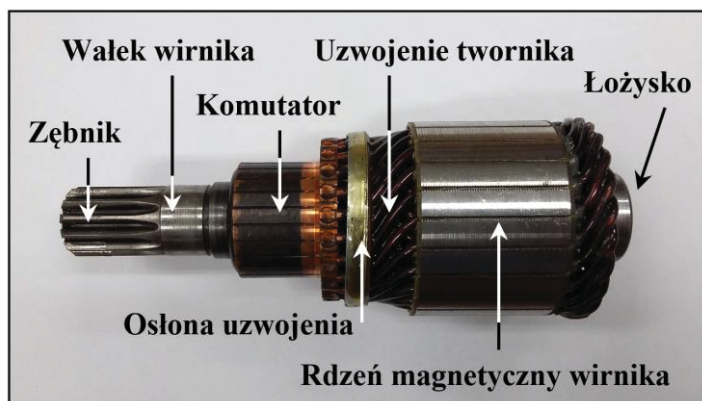
Rys. 5.2. Elementy ruchome komutatorowego silnika prądu stałego pracującego w rozruszniku samochodowym
