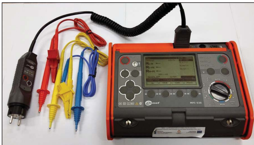
Rys. 9.1. Miernik parametrów instalacji elektrycznej z osprzętem pomiarowym
