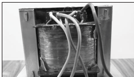
Rys. 2.3. Cewki indukcyjne jako uzwojenia transformatora
