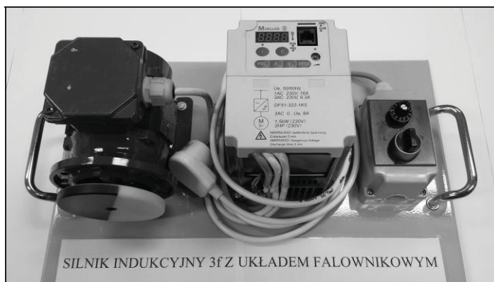
Rys. 6.6. Silnik indukcyjny trójfazowy z układem falownikowym
