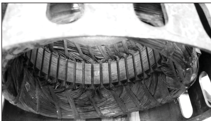
Rys. 6.3. Obudowa, rdzeń i uzwojenie wzbudzenia silnika indukcyjnego klatkowego
