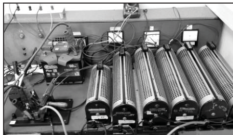
Rys. 2.2. Rezystory suwakowe na stanowisku pomiarowym
