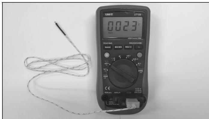
Rys. 7.1. Multimetr z czujnikiem termoelektrycznym
