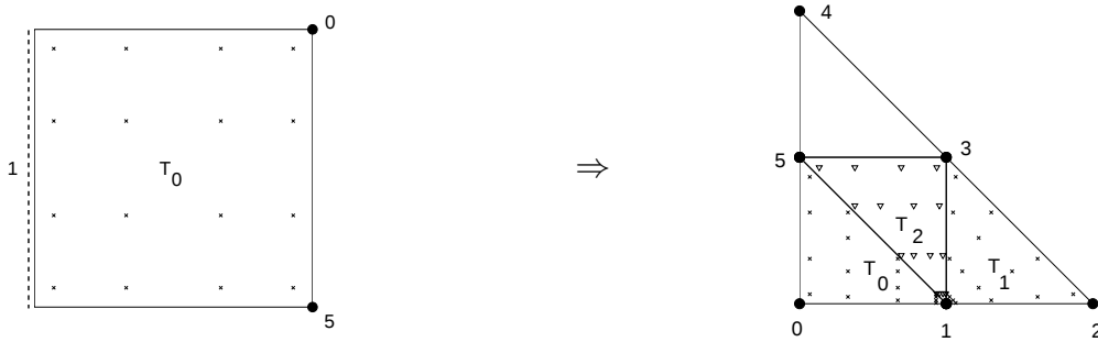
Rys. 9.3. Koncentracja punktów Gaussa dookoła punktu osobliwego znajdującego się w węźle 1
