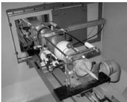
Rys. 10 Mobilna kontenerowa instalacja do deelaracji amunicji metodą poprzecznego cięcia i ukosowania łuski „Saturn” [8]
