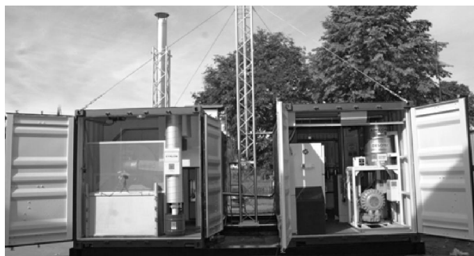
Rys. 7 Kontenerowa mobilna instalacja do pozabawiania cech bojowych amunicji strzeleckiej metodą termiczną „Jowisz” [8]
