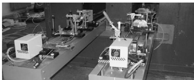
Rys. 9 Mobilna instalacja do rozbrajania i przezbrajania amunicji kaliber 20-155 mm „Mars” [8]
