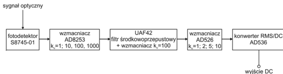
Rys. 4.38. Schemat blokowy zmodyfikowanego układu interfejsu optoelektronicznego
