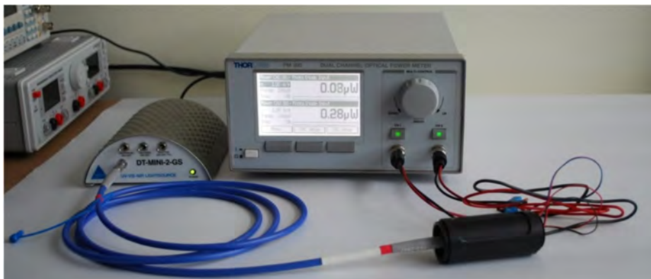
Rys. 5.39. Stanowisko do pomiarów optycznych detektora dwuzakresowego z włączonym źródłem deuterowym i wolframowym
