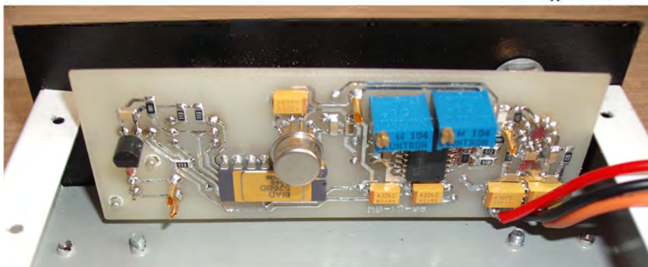
Rys. 4.35. Schemat blokowy (u góry) i opracowana konstrukcja (u dołu) interfejsu optoelektronicznego
