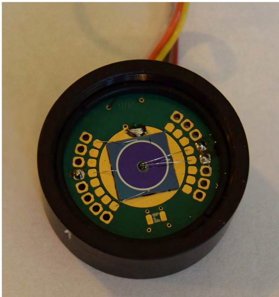
Rys. 5.29. Detektor dwuzakresowy zamontowany w obudowie firmy Thorlabs
