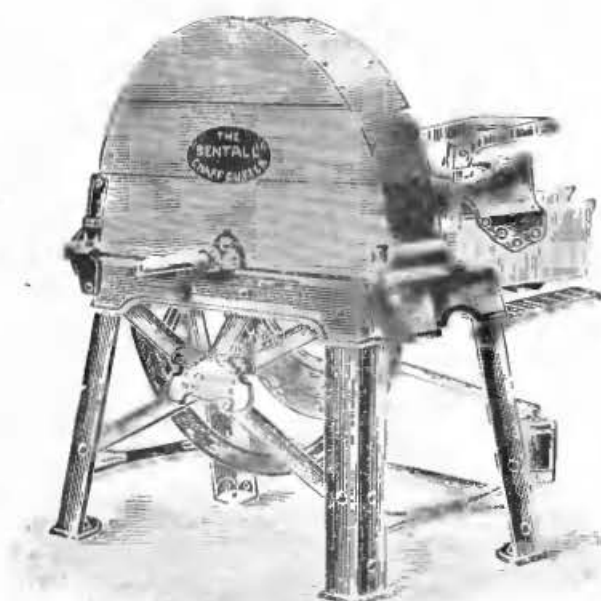
Rys. 82. Sieczkarnia angielska zabezpieczona.
