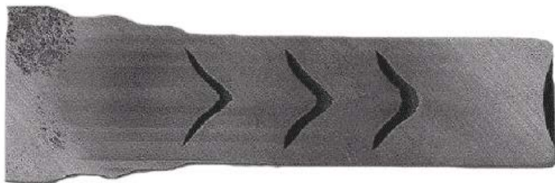
Rys. 12.31. Pęknięcia wewnętrzne obserwowane w prętach ciągnionych, przy niewłaściwie dobranej technologii wydłużania [33]
