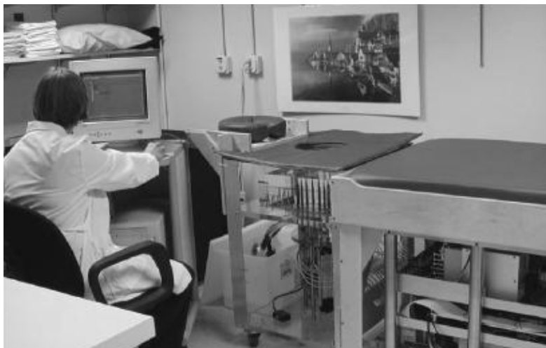
Rys. 9.3.4 System do badania tomografii mikrofalowej w Klinice Uczelnianej Dartmouth [23]
