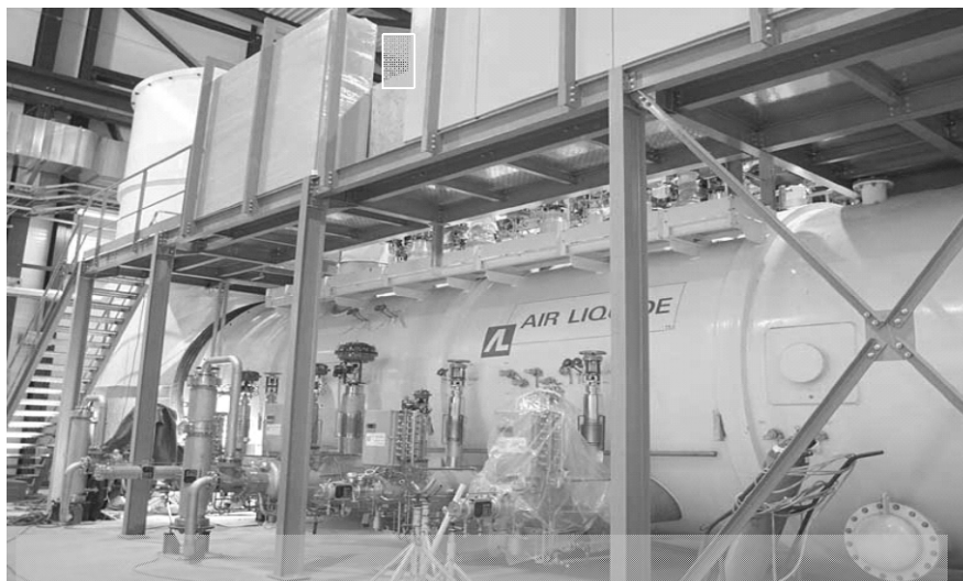
Rys.4.2.14. Skraplarka helowa 1,8 kW @ 4,5 K, o wydajności 41 gLH/s
