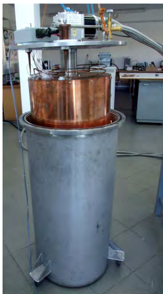
Rys.2.27. Kriostrat próżniowy przystosowany do współpracy z kriołodziarką mechaniczną
