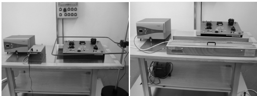
Rys 8.2.11. Znormalizowane stanowisko do badań odporności oparte na zestawie składającym się z generatora zakłóceń Modula 6000, pojemnościowego układu sprzęgającego zakłócenia Burst z torem transmisji danych - CDN 8014, układu sprzęgającego impulsy Surge w liniach transmisyjnych - CDN 117M, transformatora krokowego do zapadów napięcia - INA 6501, autotransformatora do pełnych wahań napięcia - VAR 6503, automatycznego systemu generującego pole magnetyczne (antena, układ kształtowania impulsów) - MFO6502, INA702, INA752
