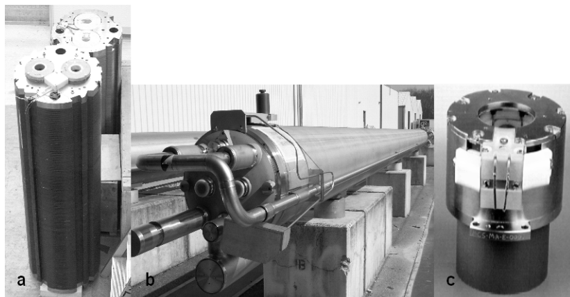
Rys. 1.6. Magnesy nadprzewodnikowe w akceleratorze LHC: główne kwadrupole (a); główne dipole w „coldmasie” (b); korektor MSC (c) [6]
