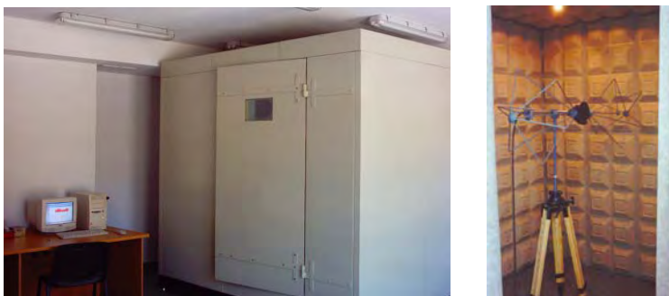
Rys.8.2.4. Zdjęcia ekranowanej komory akustycznej Instytutu IPEiE, widok na zewnątrz i wewnątrz komory
