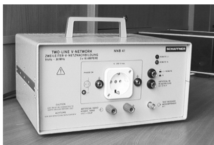
Rys.8.2.7a. Jednofazowa sieć sztuczna Two-line V-Network NNB 41, charakterystyka impedancyjna sieci sztucznej zgodnej z wymaganiami CISPR 16,
