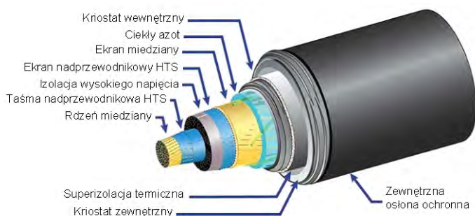
Rys. 1.15. Budowa kabla nadprzewodnikowego HTS (Nexans)
