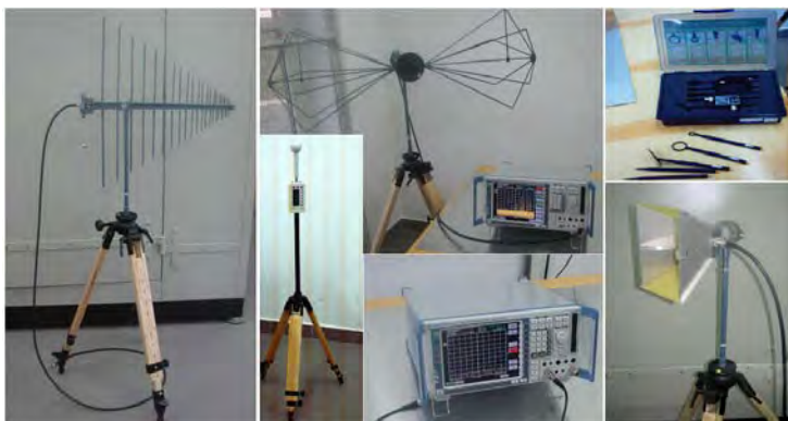
Rys.8.2.5. Zdjęcia aparatury pomiarowej do badania emisji promieniowanej na wyposażeniu Laboratorium Kompatybilności Elektromagnetycznej na Politechnice Lubelskiej (zestaw firmy Rohde&Schwarz)
