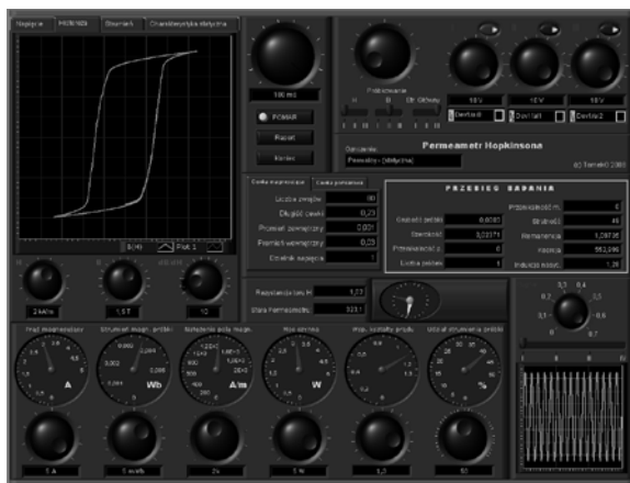
Rys. 9.2.6. Ekran systemu komputerowego do pomiaru właściwości blach elektrotechnicznych permeametrem Hopkinsona
