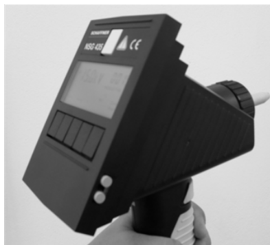
Rys.8.2.12. Znormalizowany kształt impulsu ESD oraz generator NSG 435 firmy Schaffner
