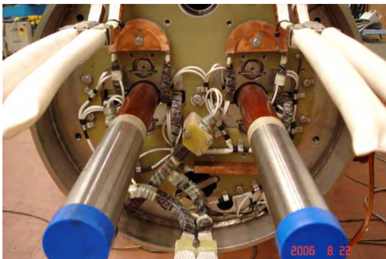
Rys. 4.2.9. Połączenia uzwojeń dipola przed przyspawaniem pokrywy
