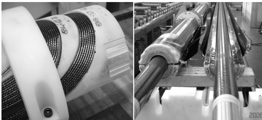
Rys. 4.2.7. Uzwojenia dipola wykonane w firmie Ansaldo Superconductor
