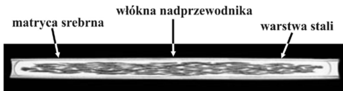
Rys. 3.3.3. Przekrój taśmy nadprzewodnikowej produkcji AMSC.
