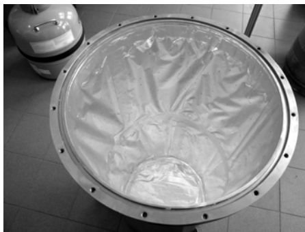
Rys. 3.3.12. Wnętrze kriostatu próżniowego wyłożone superizolacją.
