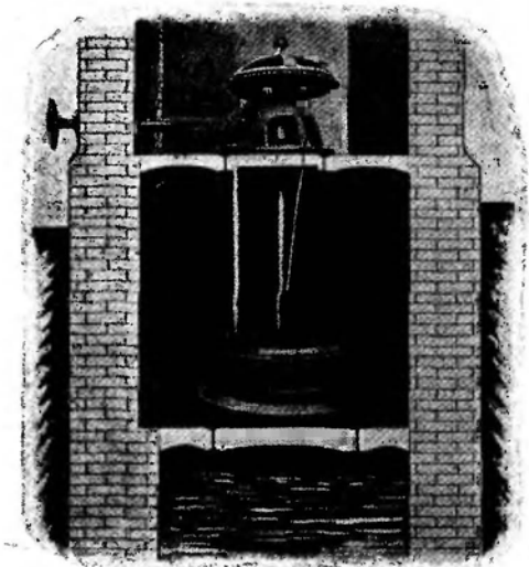
Rys. 21. Przekrój pionowy turbiny Francis'a na wale pionowym (dla małych spadków).
