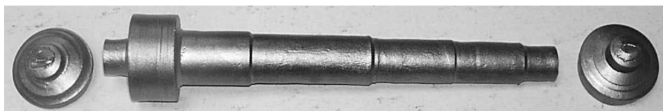
Rys. 10.22. Walcarka ULS-70, z walcami klinowymi do walcowania odkuwki wałka pośredniego, oraz odkuwka wałka z odpadami końcowymi
