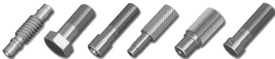
Rys. 11.9. Przykłady wyrobów, których powierzchnia zewnętrzna została ukształtowana przez nagniatanie [80]
