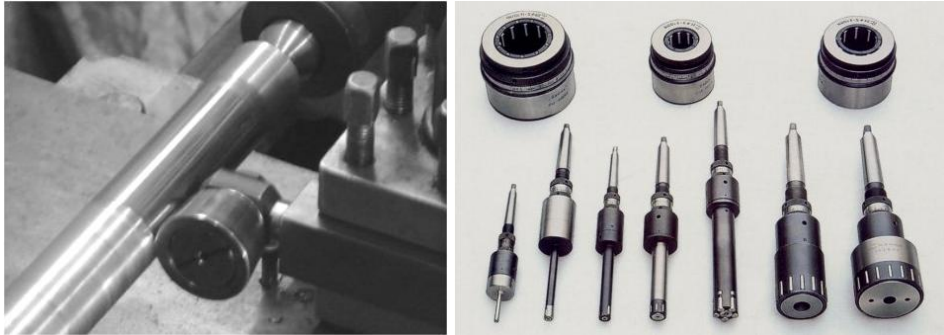
Rys. 11.2. Przykład wygładzania powierzchni zewnętrznej wałka (po lewej) oraz głowice rolkowe wykorzystywane w procesach nagniatania tocznego (po prawej) [94]
