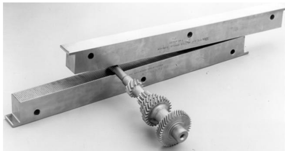
Rys. 11.17. Walcowanie uzębienia prostego metodą Roto-Flo (po lewej) oraz narzędzia wykorzystywane w tej metodzie kształtowania (po prawej) [89]
