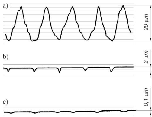
Rys. 11.6. Profilogramy powierzchni: a) toczzonej, b) nagniatanej rolką, c) dwukrotnie nagniatanej rolką [16]
