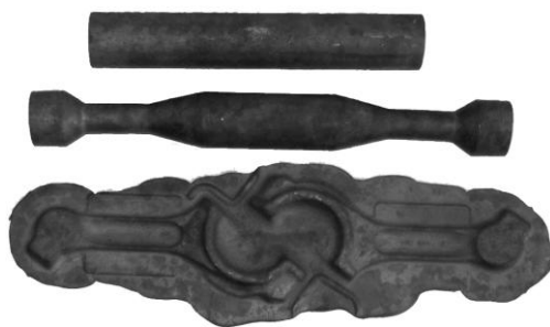
Rys. 7.16. Przykład wykonania odkuwki korbowodu sposobem kucia wielokrotnego z wykorzystaniem przedkuwki wykonanej metodą walcowania poprzeczno-klinowego
