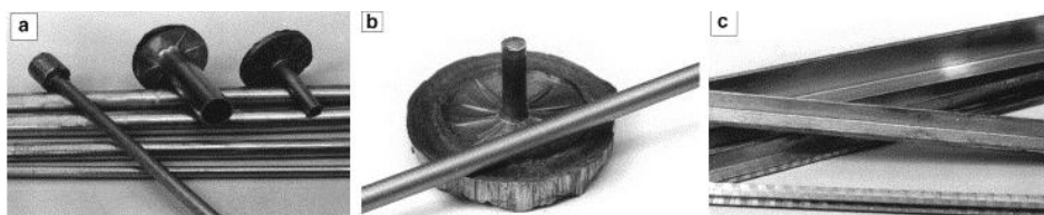
Rys. 9.11. Wypraski z miedzi (a), stopu CuP6 (b) stopów aluminium (c) otrzymane wyciskaniem KOBO prowadzonym w temperaturze pokojowej [7]
