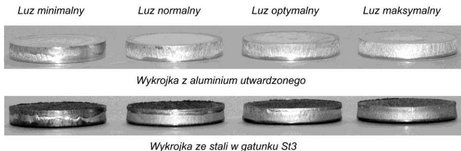
Rys. 3.5. Wpływ luzu na wygląd powierzchni rozdzielania w procesie wykrawania elementu z aluminium utwardzonego oraz stali w gatunku St3
