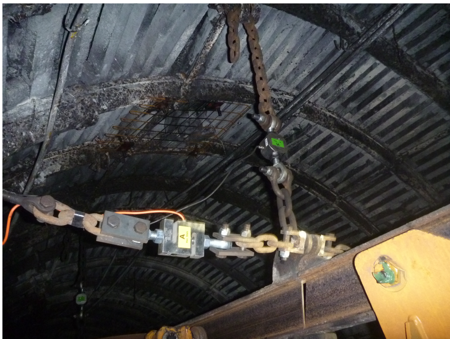
Rys. 6.1. Odciąg stabilizacyjny (A) i zawiesie pojedyncze (I) produkcji Stalpol z czujnikami siły, zamontowane na odcinku pomiarowym trasy
