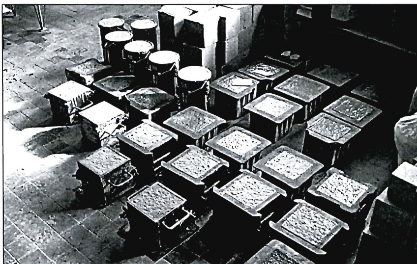
Fot. B.4. Próbkki do badań cech materiałowych betonu
