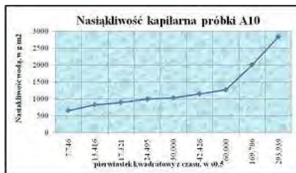
Rys. 13.32 Kapilarne podciąganie opoki (A10 – próbki, które uległy hydrofobizacji).
