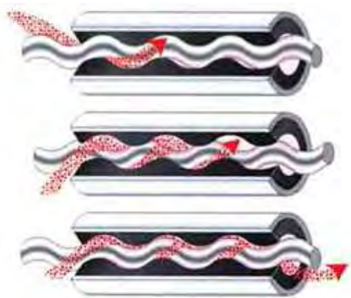
Rys. 4.7 Zasada działania pompy śrubowej[212]
