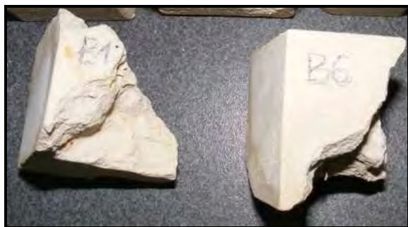
9.37 Próbkki strefy B po 15 cyklu zasolenia w roztworze 14 % siarczanu sodu
