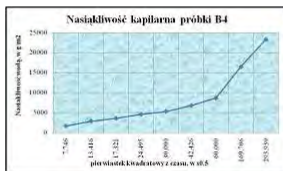
Rys. 13.42 Kapilarne podciąganie opoki (B4 – próbki, które uległy tylko w części hydrofobizacji).
