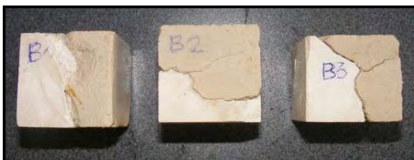
9.43 Próbki strefy B po 8 cyklu zasolenia w roztworze 14 % chlorku sodu.
