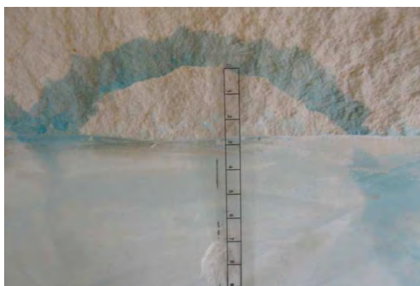
Rys. 10.5 Pomiar promienia penetracji preparatu w opoce
