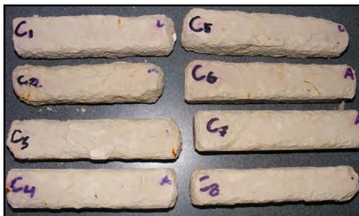
Rys. 13.71 Próbki C. Fotografia wykonana po 42 cyklu rozmrażania.
