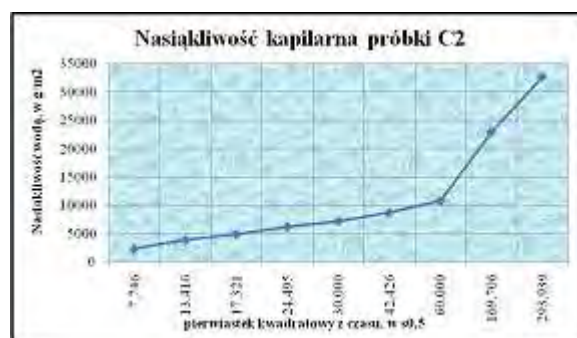
Rys. 13.56 Kapilarne podciąganie opoki (C2 – próbki niezabezpieczone preparatem).
