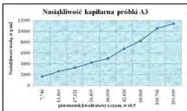
Rys. 13.25 Kapilarne podciąganie opoki (A3 – próbki, które uległy hydrofobizacji).
