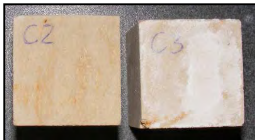
9.48 Próbki strefy C po 15 cyklach zasolenia w roztworze 14 % azotanem sodu.
