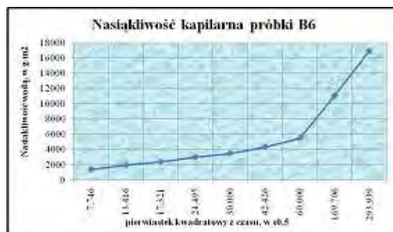
Rys. 13.44 Kapilarne podciąganie opoki (B6 – próbki, które uległy tylko w części hydrofobizacji).
