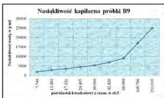
Rys. 13.47 Kapilarne podciąganie opoki (B9 – próbki, które uległy tylko w części hydrofobizacji)
