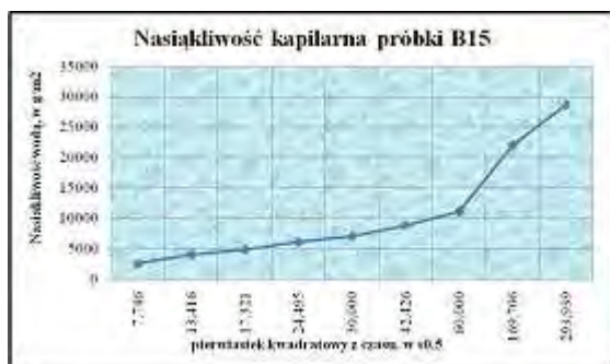
Rys. 13.53 Kapilarne podciąganie opoki (B15 – próbki, które uległy tylko w części hydrofobizacji).
