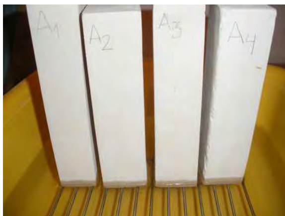
Rys. 9.27 Badanie kapilarnego podciągania opoki strefa A po godzinie badania.
