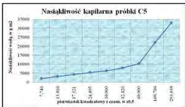
Rys. 13.59 Kapilarne podciąganie opoki (C5 – próbki niezabezpieczone preparatem).
