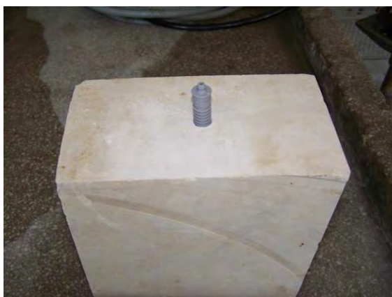
Rys. 9.1 Przygotowanie próbka z opoki do badań
