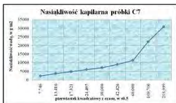
Rys. 13.61 Kapilarne podciąganie opoki (C7 – próbki niezabezpieczone preparatem).
