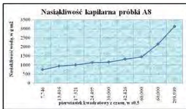
Rys. 13.30 Kapilarne podciąganie opoki (A8 – próbki, które uległy hydrofobizacji).
