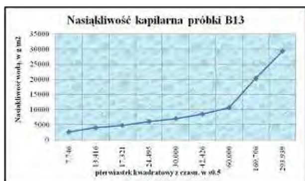
Rys. 13.51 Kapilarne podciąganie opoki (B13 – próbki, które uległy tylko w części hydrofobizacji).
