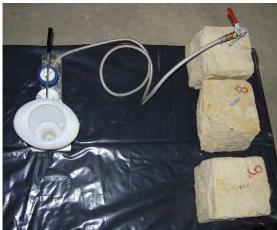
Rys. 9.5 Próbkę z opoki przygotowaną do procesu hydrofobizacji wgłębnej.
