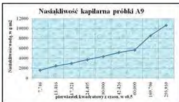
Rys. 13.31 Kapilarne podciąganie opoki (A9 – próbki, które uległy hydrofobizacji).
