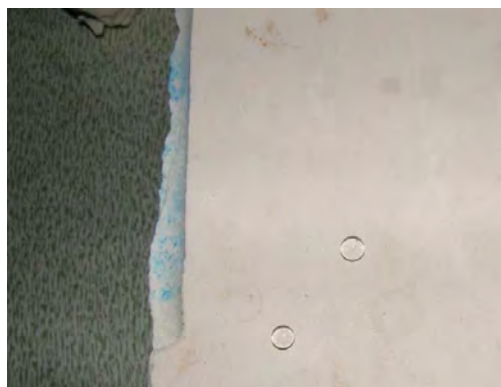
Rys. 9.12 Próbka III 6. badanie skuteczności hydrofobizacji metodą absorpcji kropli wody
