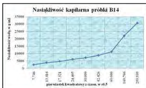
Rys. 13.52 Kapilarne podciąganie opoki (B14 – próbki, które uległy tylko w części hydrofobizacji).
