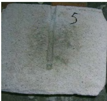
Rys. 9.15 Próbką z zaprawy wapiennej po procesie tłoczenia emulsji silikonowej
