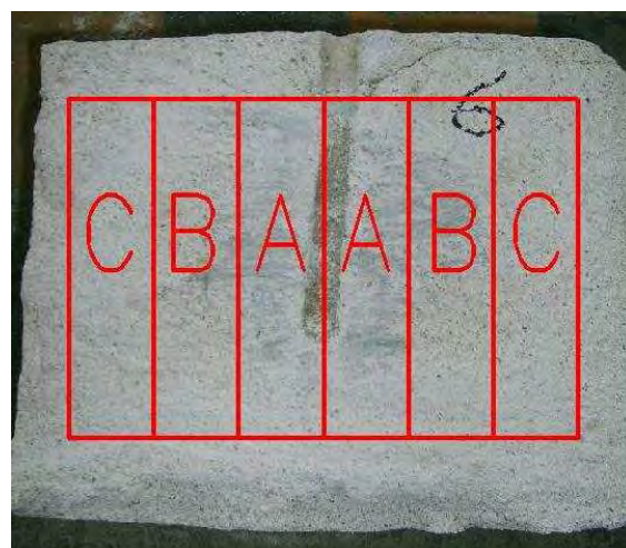
Rys. 9.60 Rozkład stref poboru próbek z walca hydrofobizowanej zaprawy wapiennej
