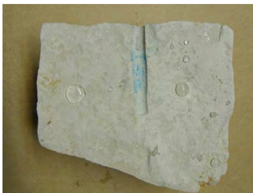
Rys. 9.11 Próbka II 10. Widoczny efekt hydrofobizacji na powierzchni przecięcia.
