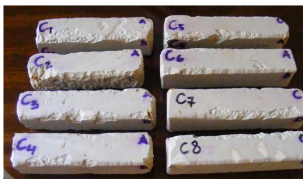
Rys. 13.68 Próbki C. Fotografia wykonana po 28 cyklu rozmrażania.
