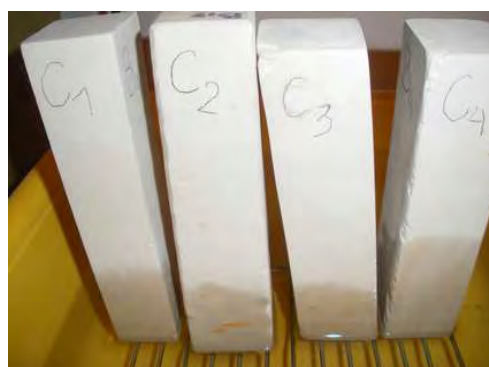
Rys. 9.29 Badanie kapilarnego podciągania opoki strefa C po godzinie badania.
