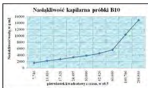
Rys. 13.48 Kapilarne podciąganie opoki (B10 – próbki, które uległy tylko w części hydrofobizacji)
