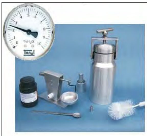
3.11 Wilgotnościomierz karbidowy WK-1
