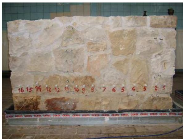
Rys. 10.18 Widok muru przygotowanego do tłoczenia
