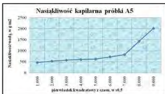
Rys. 13.27 Kapilarne podciąganie opoki (A5 – próbki, które uległy hydrofobizacji).
