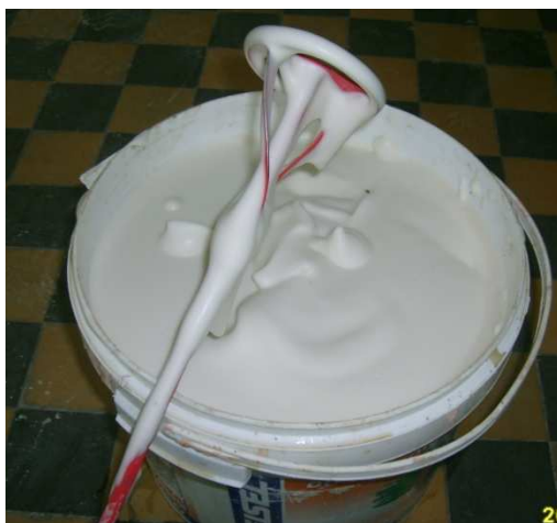
Rys. 8.10 Przygotowywanie piany do wymieszania z zaprawą trasową.
