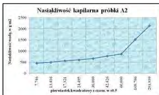
Rys. 13.24 Kapilarne podciąganie opoki (A2 – próbki, które uległy hydrofobizacji).
