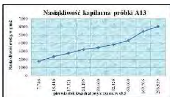
Rys. 13.35 Kapilarne podciąganie opoki (A13 – próbki, które uległy hydrofobizacji).
