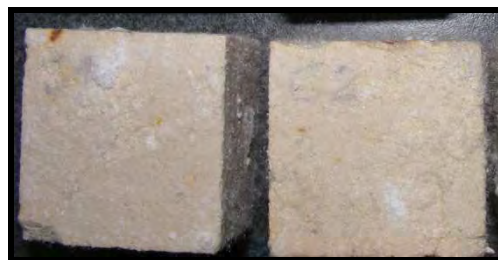
9.46 Próbkki strefy C po 15 cyklu zasolenia w roztworze 14 % chlorku sodu.
