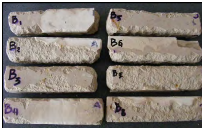
Rys. 13.70 Próbki B. Fotografia wykonana po 42 cyklu rozmrażania.
