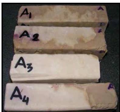
Rys. 13.72 Próbki A. Fotografia wykonana po 56 cyklu rozmrażania.
