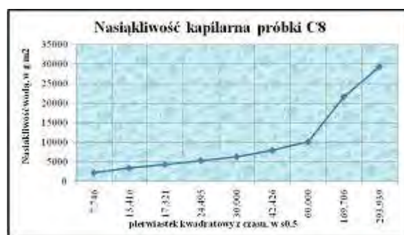
Rys. 13.62 Kapilarne podciąganie opoki (C8 – próbki niezabezpieczone preparatem).
