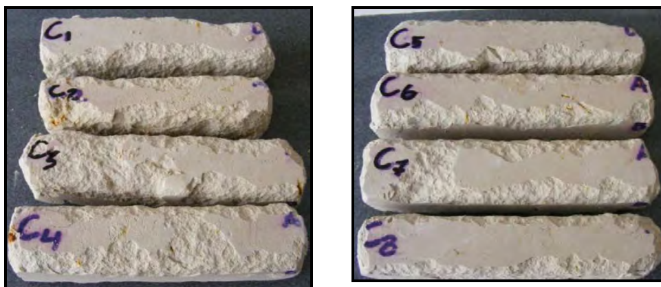
Rys. 9.32 Próbki C. Fotografia wykonana po 56 cyklu rozmrażania próbek z opoki.
