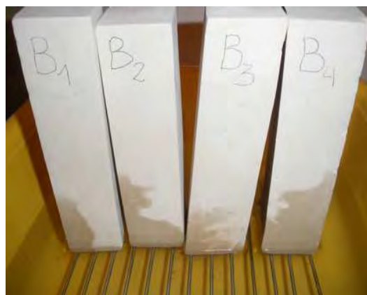
Rys. 9.28 Badanie kapilarnego podciągania opoki strefa B po godzinie badania.
