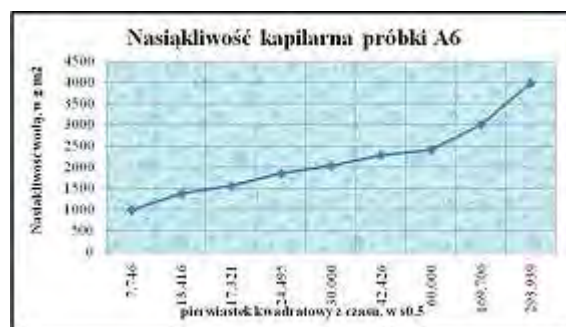
Rys. 13.28 Kapilarne podciąganie opoki (A6 – próbki, które uległy hydrofobizacji).
