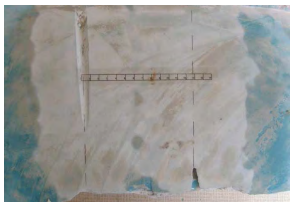
Rys. 10.4 Przy rozstawie 12 cm strefy hydrofobizowanej dwoma otworami opoki stykają się.
