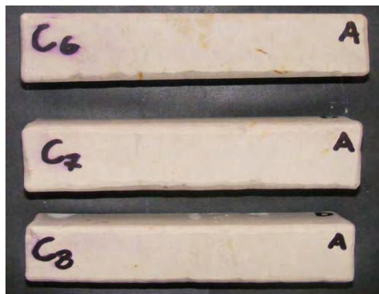
Rys. 9.18 Wycięte i przygotowane do badań próbki strefy C
