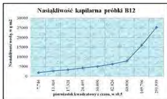
Rys. 13.50 Kapilarne podciąganie opoki (B12 – próbki, które uległy tylko w części hydrofobizacji).
