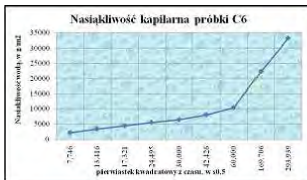
Rys. 13.60 Kapilarne podciąganie opoki (C6 – próbki niezabezpieczone preparatem).
