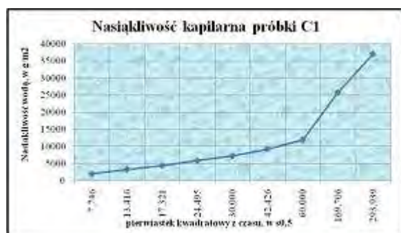
Rys. 13.55 Kapilarne podciąganie opoki (C1 – próbki niezabezpieczone preparatem).
