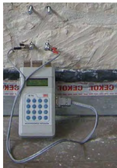
Rys. 10.11 Pomiar wilgotności miernikiem LB-795
