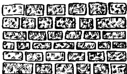
Rys. 5.12 Mur wykonany z kamienia łupanego rzędowo[103]
