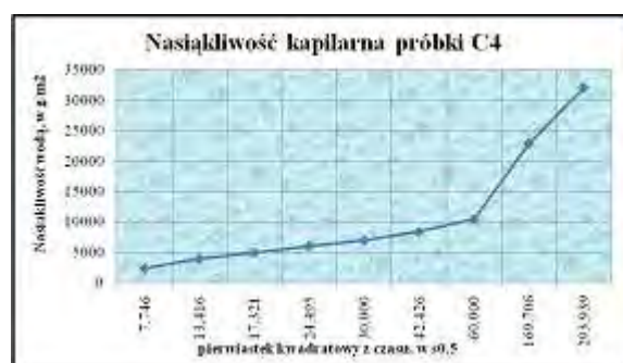
Rys. 13.58 Kapilarne podciąganie opoki (C4 – próbki niezabezpieczone preparatem)
