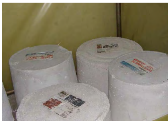
Rys. 9.4 Próbk z zaprawy wapiennej przed rozpoczęciem procesu karbonizacji.
