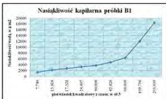
Rys. 13.39 Kapilarne podciąganie opoki (B1 – próbki, które uległy tylko w części hydrofobizacji).
