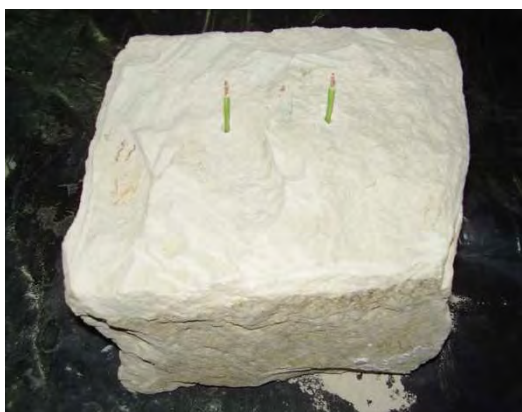
Rys. 9.3 Widok próbki z opoki z zamontowanymi sędami do pomiaru wilgotności.
