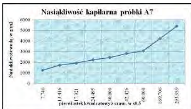
Rys. 13.29 Kapilarne podciąganie opoki (A7 – próbki, które uległy hydrofobizacji).
