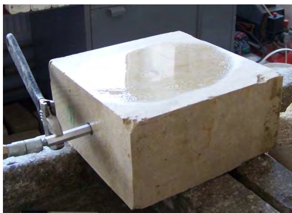
Rys. 9.2 Proces iniekcji opoki.
