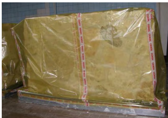
Rys. 10.8 Widok muru w kołnierzu podczas procesu karbonizacji.
