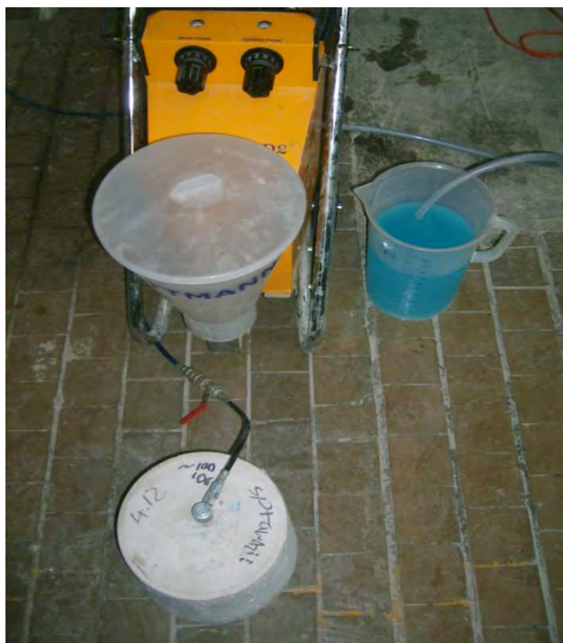
Rys. 9.7 Proces tłoczenia preparatu II w próbce z zaprawy trasowej.
