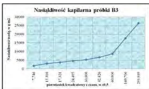
Rys. 13.41 Kapilarne podciąganie opoki (B3 – próbki, które uległy tylko w części hydrofobizacji).
