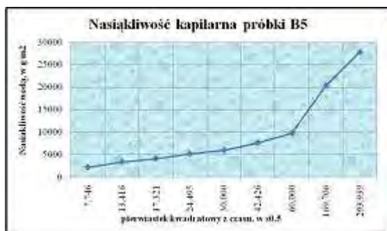
Rys. 13.43 Kapilarne podciąganie opoki (B5 – próbki, które uległy tylko w części hydrofobizacji).
