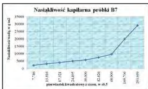
Rys. 13.45 Kapilarne podciąganie opoki (B7 – próbki, które uległy tylko w części hydrofobizacji).
