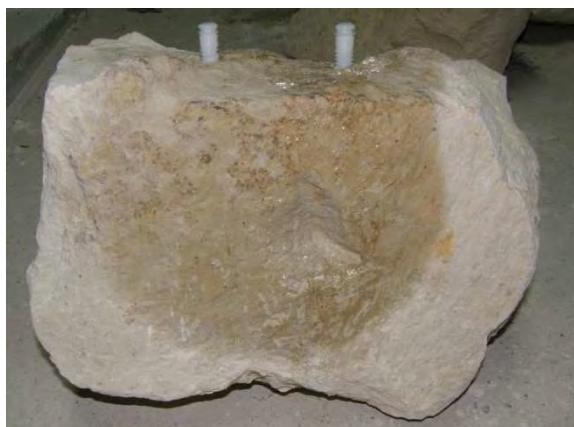
Rys. 10.1 Blok opoki po procesie tłoczenia preparatu II. Widok z boku
