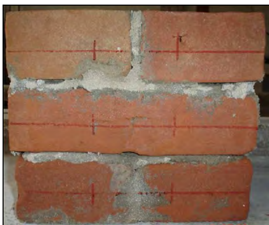
Rys. 3.4 Próbką z cegły ceramicznej przygotowana do badań.
