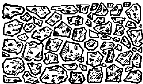
Rys. 5.4 Mur wykonany z kamienia łamanego niesortowanego[103]
