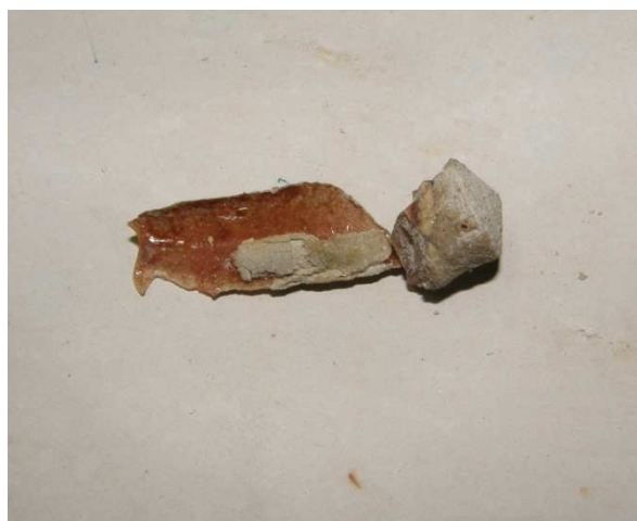
Rys. 9.10 Czop z krzemianu modyfikowanego silikonem wyjęty z otworu.
