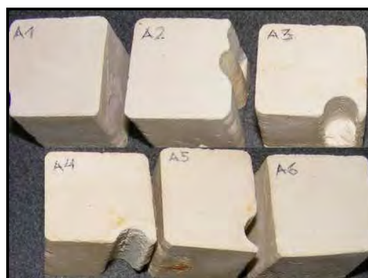
9.34 Próbki strefy A po 15 cyklach zasolenia w roztworze 14 % siarczanu sodu.
