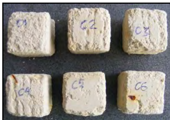
9.39 Próbkki strefy C po 2 cyklu zasolenia w roztworze 14 % siarczanu sodu
