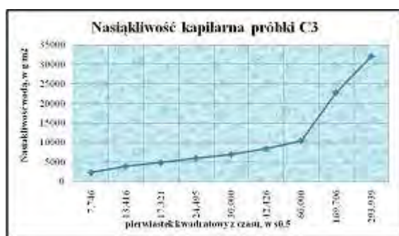
Rys. 13.57 Kapilarne podciąganie opoki (C3 – próbki niezabezpieczone preparatem)
