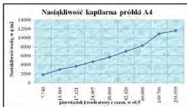
Rys. 13.26 Kapilarne podciąganie opoki (A4 – próbki, które uległy hydrofobizacji).
