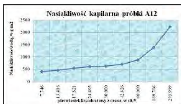
Rys. 13.34 Kapilarne podciąganie opoki (A12 – próbki, które uległy hydrofobizacji).
