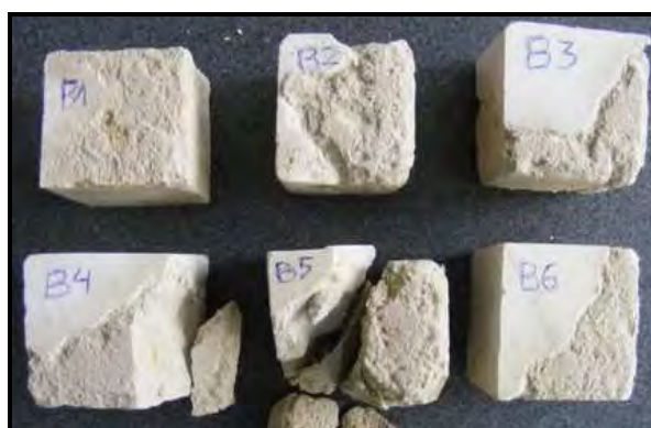
9.36 Próbki strefy B po 2 cyklu zasolenia w roztworze 14 % siarczanu sodu
