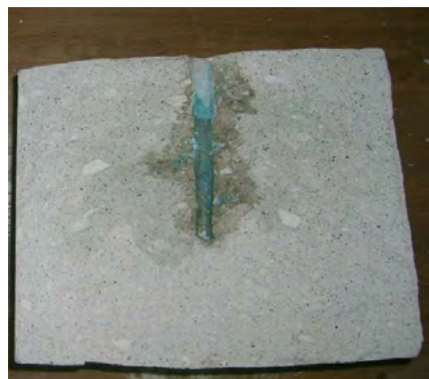
Rys. 9.16 Próbką z zaprawy wapienno-cementowej po procesie tłoczenia emulsji silikonowej
