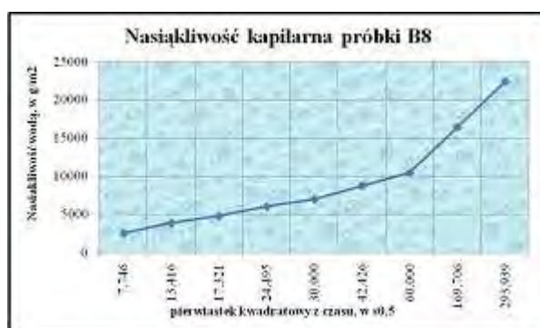
Rys. 13.46 Kapilarne podciąganie opoki (B8 – próbki, które uległy tylko w części hydrofobizacji).
