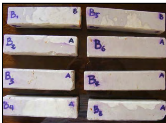
Rys. 13.67 Próbki B. Fotografia wykonana po 28 cyklu rozmrażania.
