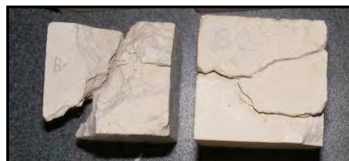
9.44 Próbki strefy B po 10 cyklu zasolenia w roztworze 14 % chlorku sodu
