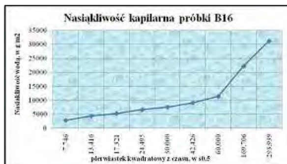
Rys. 13.54 Kapilarne podciąganie opoki (B16 – próbki, które uległy tylko w części hydrofobizacji).
