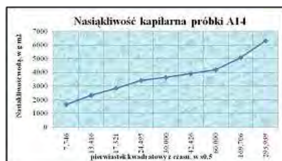
Rys. 13.36 Kapilarne podciąganie opoki (A14 – próbki, które uległy hydrofobizacji).
