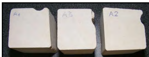
9.42 Próbki strefy A po 15 cyklach zasolenia w roztworze 14 % chlorku sodu.
