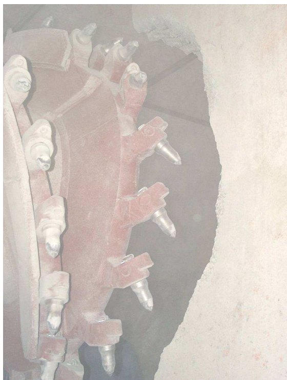
Rys. 5.20. Głowica wielonarzędziowa z zamontowanym zespołem noży styczno-obrotowych
