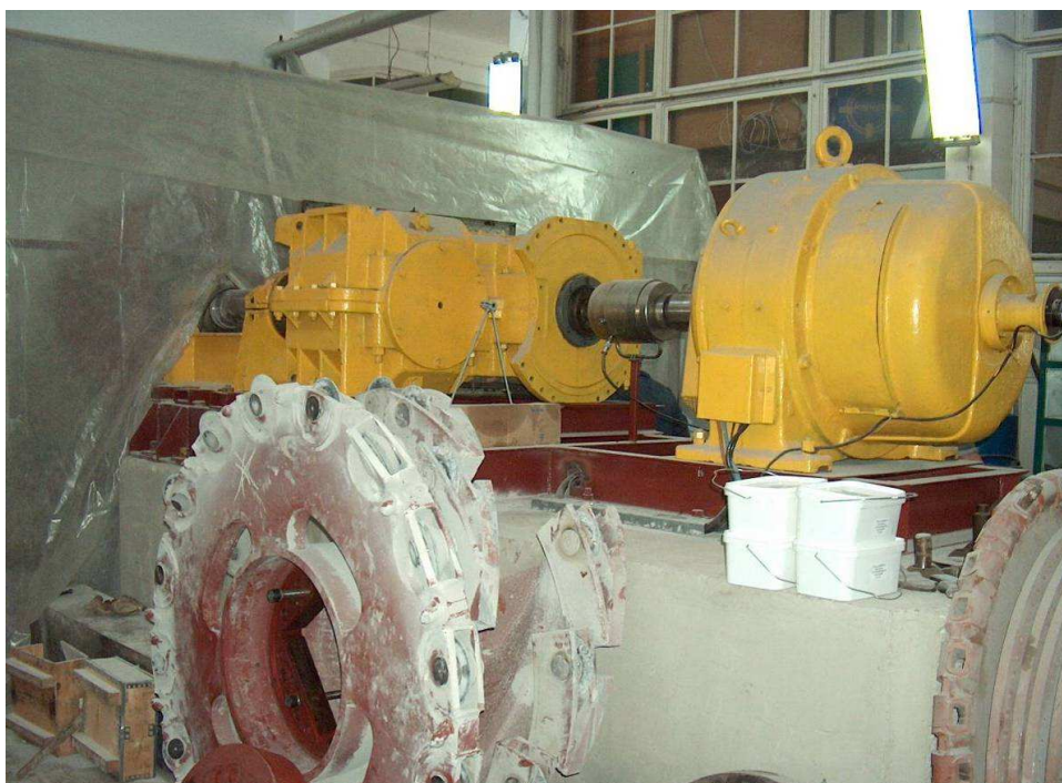
Rys.4.3. Stanowisko do badania procesu urabiania głowicą wielonarzędziową- układ napędowy głowicy
