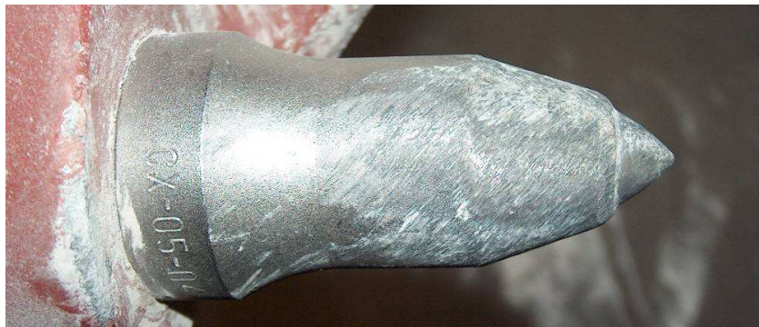
Rys. 5.19. Nóż styczno obrotowy, w trakcie badań laboratoryjnych
