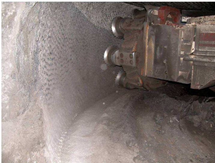
Rys. 3.17. Maszyna wyposażona w głowicę zbrojoną dyskami (a), przeznaczona do urabiania skał o bardzo dużej zwięzłości i ścierności (b) [32]
