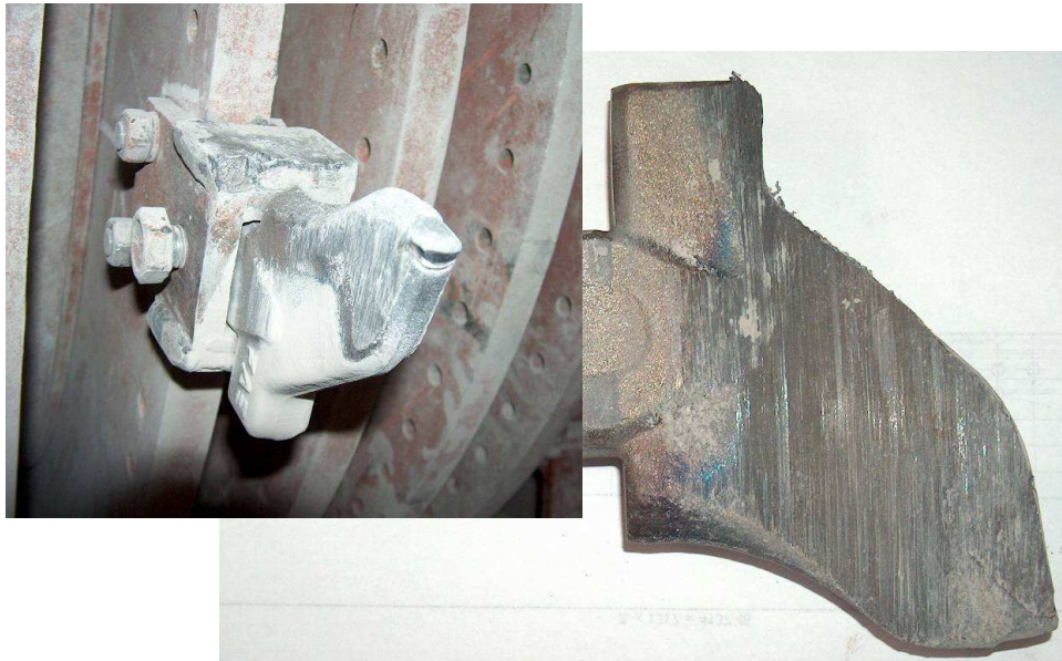
Rys. 5.21. Narzędzia częściowo zużyte, podczas badań laboratoryjnych
