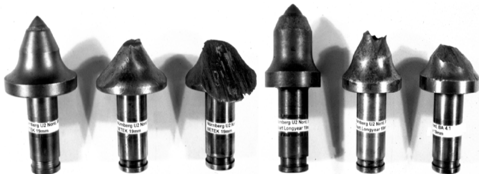
Rys. 3.39. Obserwowane formy zużycia noży obrotowych, wg [78]
