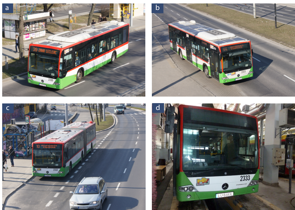
Ryc. 9.1. Badane autobusy z zainstalowanymi systemami fotowoltaicznymi: Mercedes Conecto LF (a,b), Conecto G (c,d) [173]
