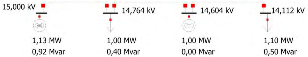
Rys. 5.4 Schemat małej sieci zamodelowanej w programie PowerWorld z wynikami obliczeń
