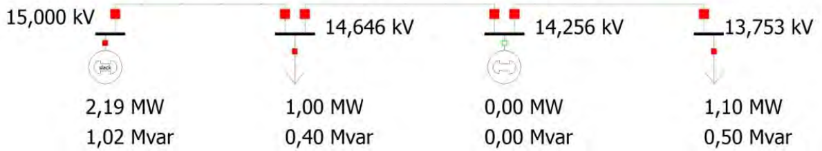
Rys. 5.5 Schemat układu z wynikami obliczeń dla sieci pasywnej
