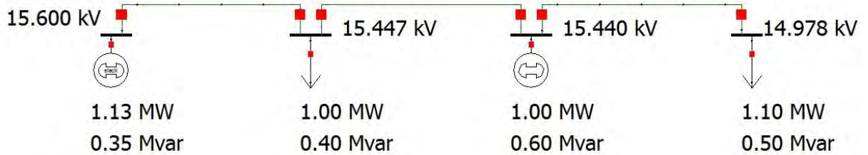
Rys. 5.8 Schemat układu z wynikami dla optymalnej wartości napięcia w GPZ i mocy biernej w źródle
