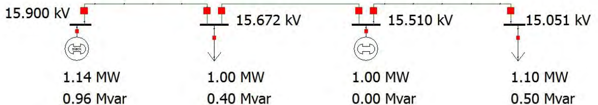
Rys. 5.9 Schemat układu z wynikami dla optymalnej wartości napięcia w GPZ i zerowej mocy biernej w źródle
