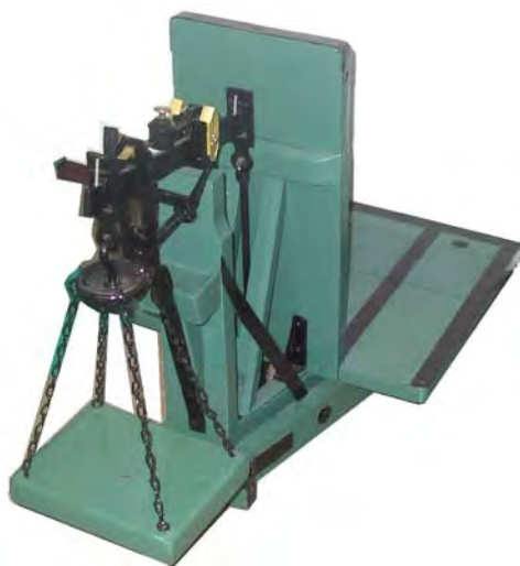
Ryc. 19. Waga dziesiętna z początku XX wieku, pomost i podstawa wykonana z drewna (zbiory FAWAG)
