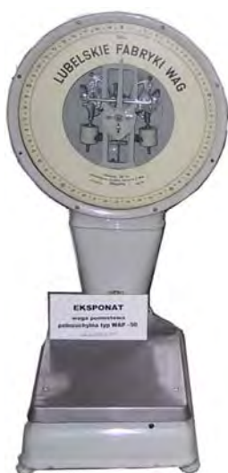
Ryc. 24. Waga mechaniczna z głowicą pełnouchylną typu WAP-50 (produkcja 1975 r.)
