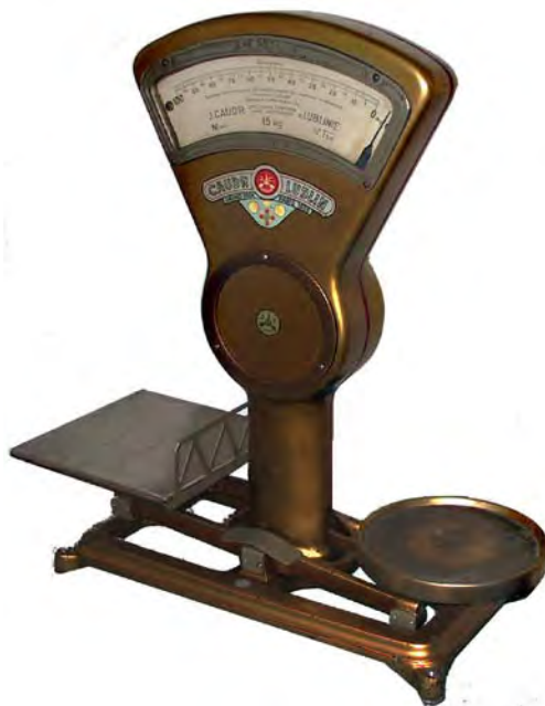
Ryc. 22. Waga uchylna produkcji fabryki Caudra o zakresie ważenia do 15 kg
