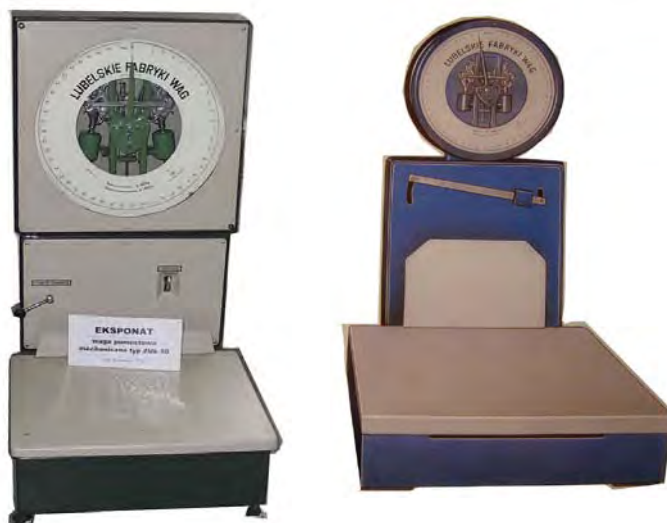
Ryc. 25. Wagi mechaniczne z głowicą pełnouchylną typu ZUK-50 (produkcja 1978 r.)
