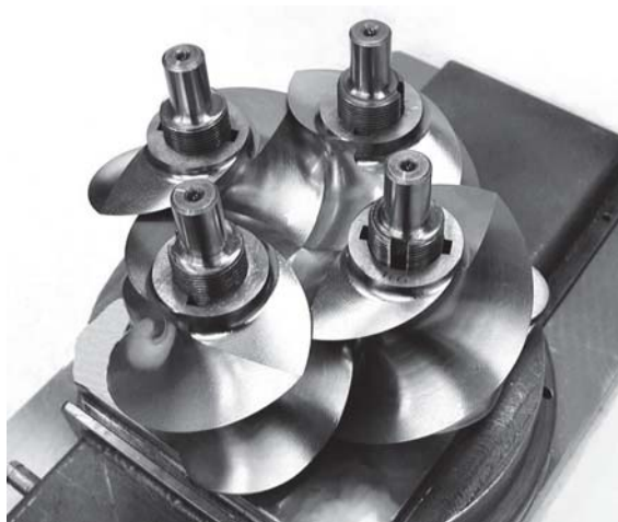
Rys. 1.1. Prototyp sprężarki z zespołem czterech współbieżnych rotorów śrubowych w trakcie montażu (odjęta płyta przednia i osłona boczna )
