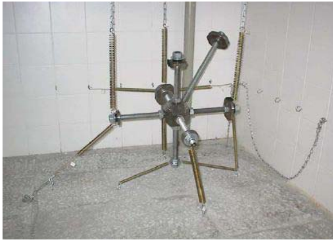
Rys. 10.11. Stanowisko pomiarowe dla metody FRF [2]
