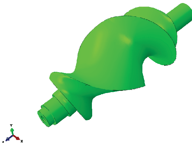
Rys. 2.10. Postać drgań własnych (Moda 2) przy częstotliwości 3477.2 [Hz]
