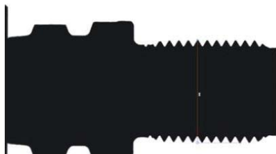
Rys. 10.13. Wykorzystanie technik widzenia maszynowego: pomiar średnicy zewnętrznej gwintu [21]
