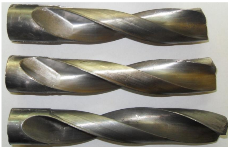
Rys. 4.19. Wiertła kręte wyciskane w matrycach dzielonych
