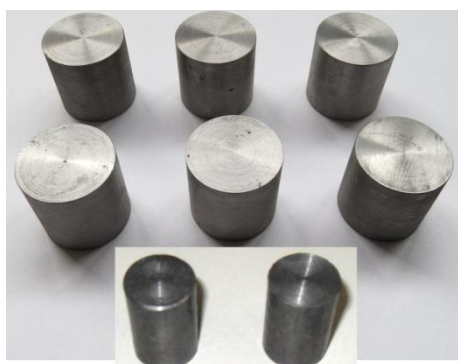
Rys. 4.2. Próbkę walcowe wykorzystane w badaniach warunków tarcia
