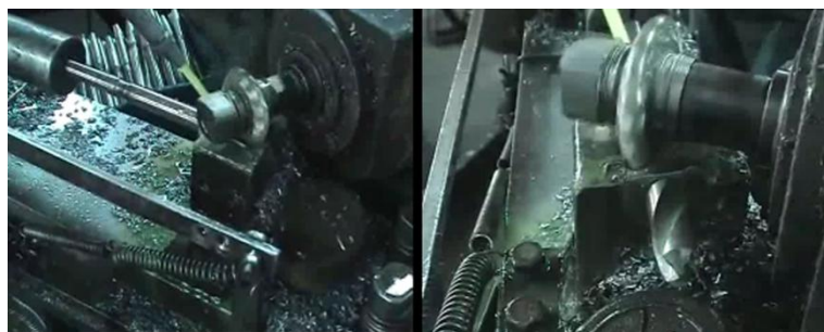
Rys. 3.9. Frezowanie rowków wiórowych wiertła krętego w zakładach ECEF [65]
