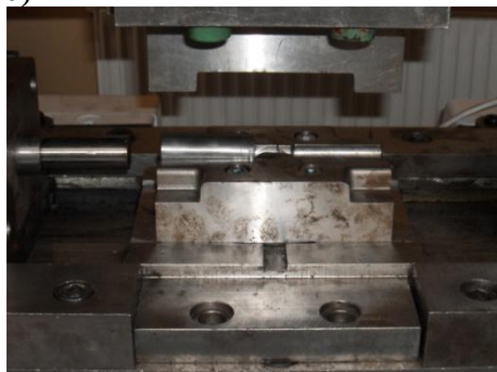
Rys. 4.18. Przebieg wyciskania wiertel krętych: a) umieszczenie wsadu w wykroju dolnej matrycy, b) rozsuniecie matrycy w celu usunięcia wyciśniętego wiertła
