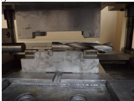
Rys. 4.18. Przebieg wyciskania wiertel krętych: a) umieszczenie wsadu w wykroju dolnej matrycy, b) rozsuniecie matrycy w celu usunięcia wyciśniętego wiertła
