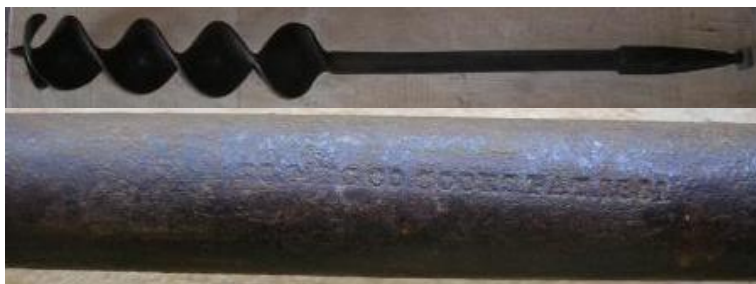
Rys. 2.6. Świder do drewna wykonany wg patentu Cook'a z 1770 roku [67]
