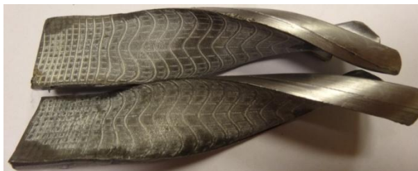
Rys. 4.22. Obraz odkształconej siatki koordynacyjnej naniesionej na połówki wsadu w przekroju osiowym
