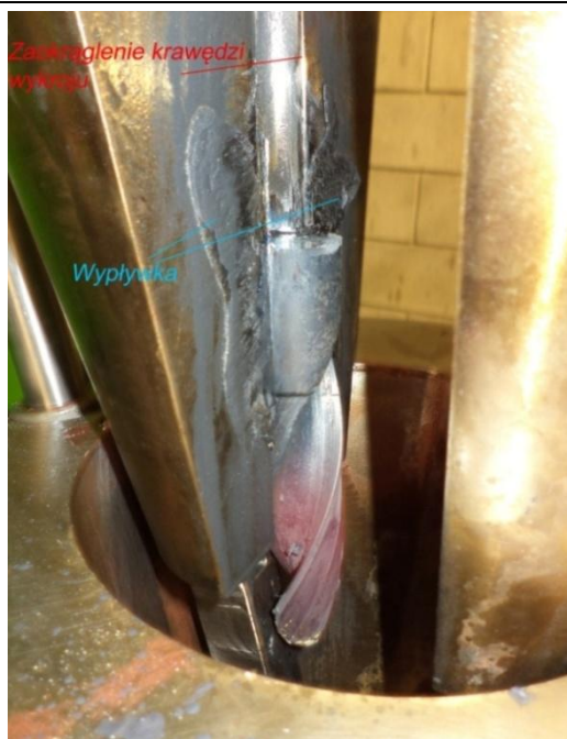
Rys. 6.15. Wypływka powstała w płaszczyźnie złożenia matryc
