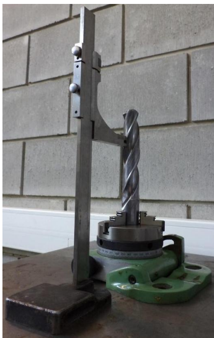
Rys. 6.9. Stanowisko wykorzystane do pomiaru kąta pochyleń rowków wiórowych
