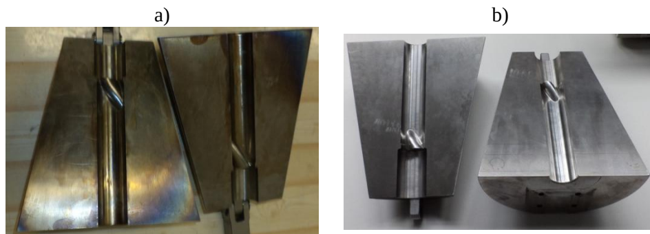
Rys. 6.10. Matryce wykorzystane w badaniach doświadczalnych: a) zestaw matrycowy I, b) zestaw matrycowy II
