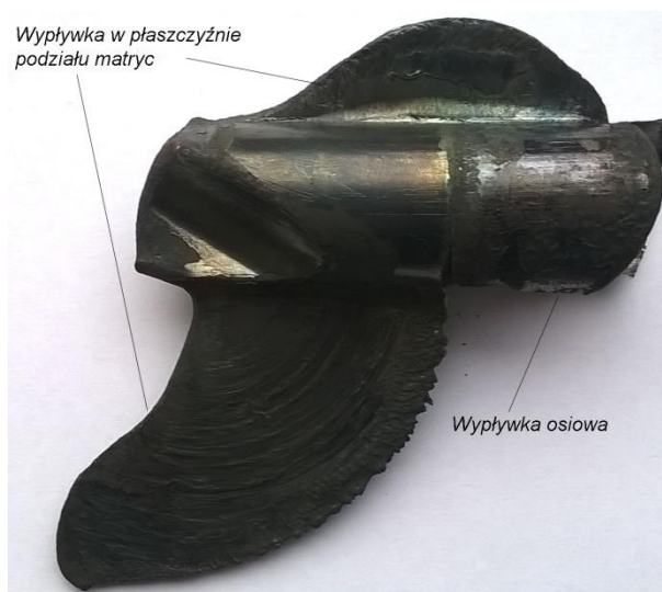
Rys. 4.24. Ograniczenie procesu wyciskania spowodowane otworem matryc
