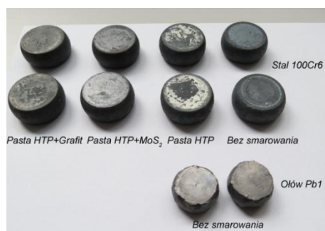
Rys. 4.3. Próbkę spęcone przy różnych warunkach smarowania
