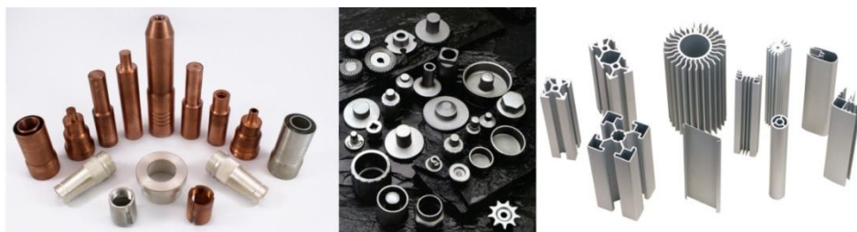
Rys. 3.35. Przykłady wyrobów o złożonej geometrii wytwarzanych metodą wyciskania [71, 74, 77]
