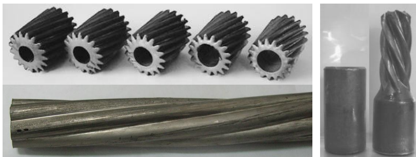
Rys. 3.38. Przykłady wyrobów uzyskanych w procesie wyciskania śrubowego [90, 102, 185]
