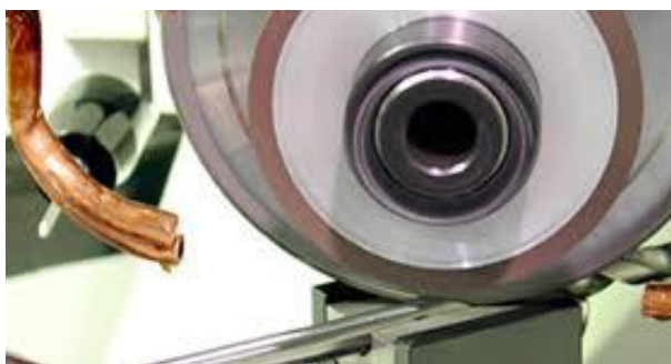
Rys. 3.10. Szlifowanie rowka wiórowego [86]
