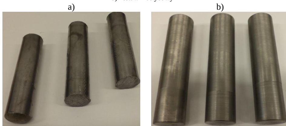
Rys. 7.11. Przykładowy materiał wsadowy wykorzystane w trakcie badań eksperymentalnych: a) pręty z ołowiu Pb1, b) pręty stalowe 100Cr6
