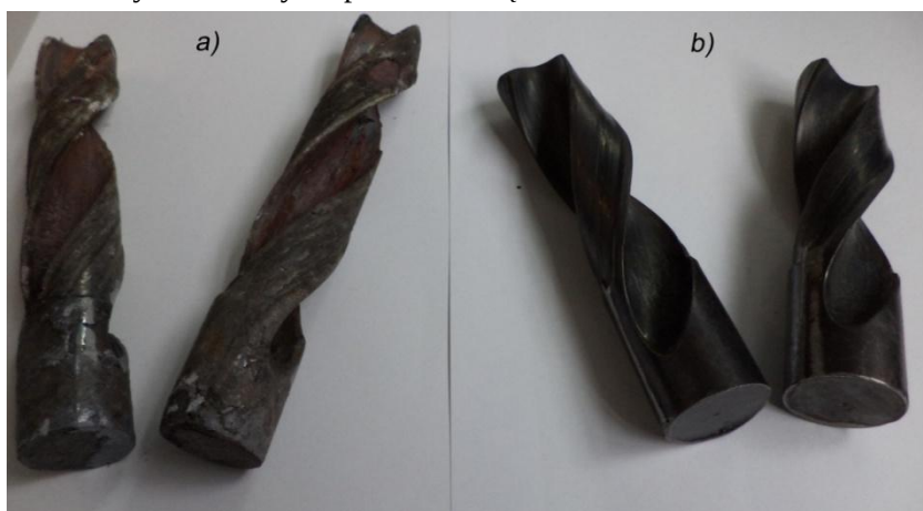
Rys. 6.13. Półfabrykaty wiertel krętych ze stali 100Cr6 wyciskane w: a) zestawie narzędziowym II, b) zestawie narzędziowym I
