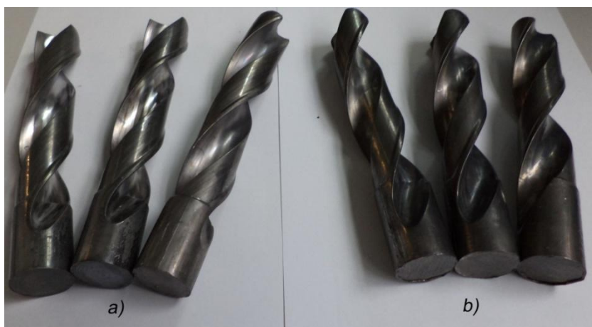
Rys. 6.14. Półfabrykaty wiertel krętych z ołowiu Pb1 wyciskane w: a) zestawie narzędziowym II, b) zestawie narzędziowym I
