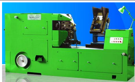
Rys. 3.14. Automat do walcowania wiertel krętych HNJ1220 firmy TDG-MT Co., Ltd [79]
