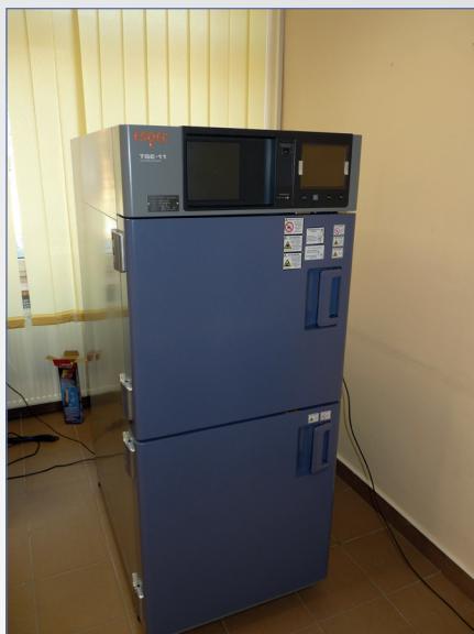
Komora szoków termicznych ESPEC TSE-11
