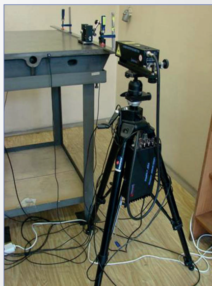
Interferometr laserowy LSP30 Compact
