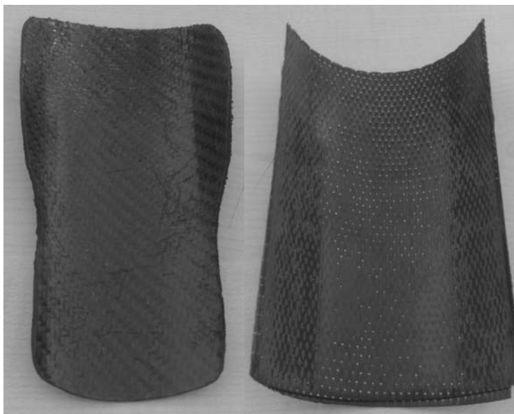
Rys. 16. Efekty Prasowania półokrągłych laminatów metodą PRM
