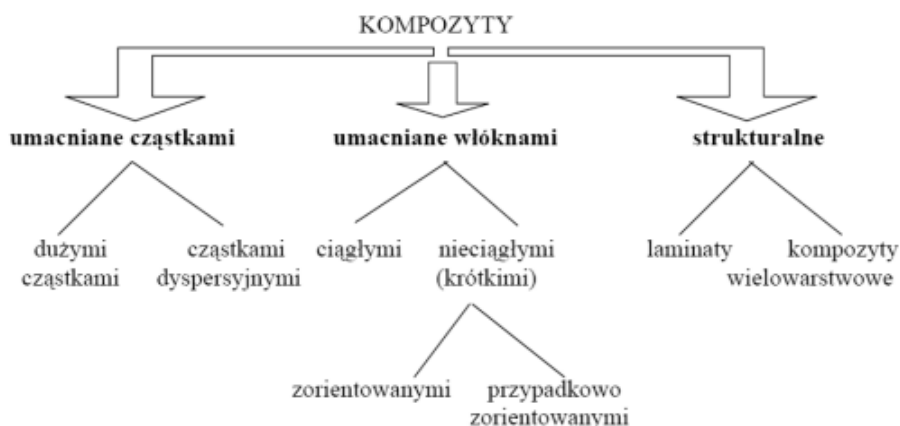
Rys. 3. Podział kompozytów z uwzględnieniem typu fazy rozproszonej [6]
