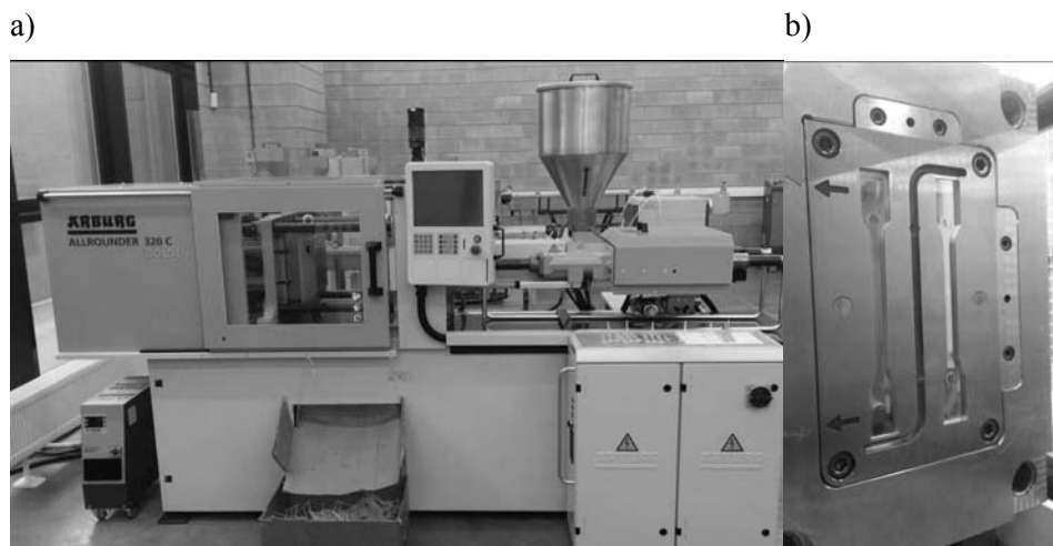
Rys. 1. Wygląd a) wtryskarki ślimakowej ARBURG ALLROUNDER 320C b) gniazda formy wtryskowej do wytwarzania próbek w kształcie wioselek.
