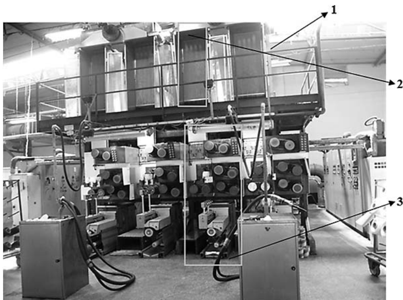
Rys. 3. Widok ogólny stanowiska do produkcji przędzy na bazie polimerów włóknotwórczych [14]: 1 – ślimakowy układ uplastyczniający, 2 – dysza przędzalnicza, 3 – zespół wałków kalandrujących
