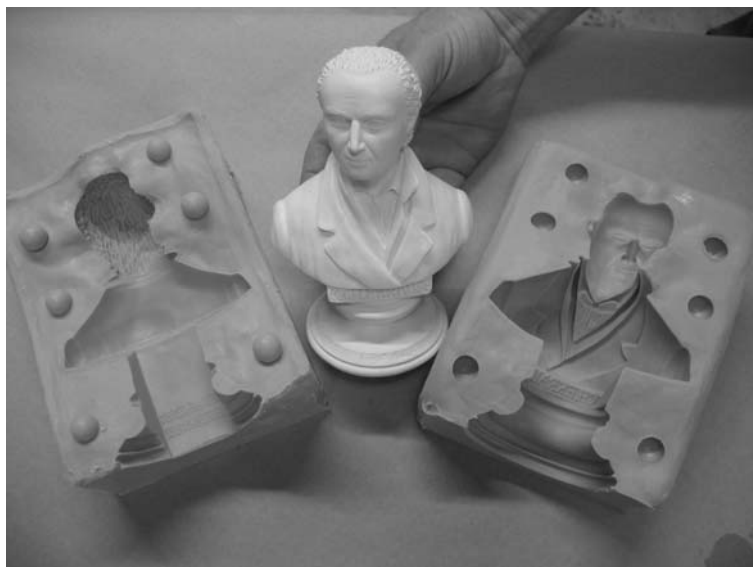
Rys. 2. Przykład gotowego odlewu wykonanego za pomocą dwuczęściowej formy elastycznej [11]
