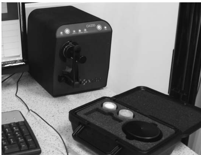
Rys. 4. Stanowisko do pomiaru barwy ze spektrofotometrem X-Rite Ci4200 i zestawem kalibracyjnym
