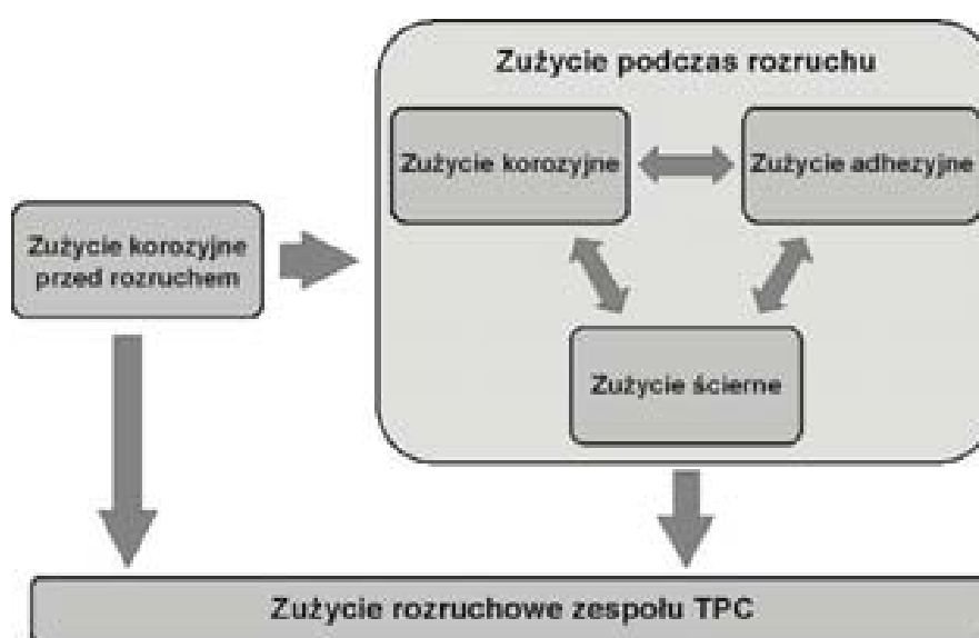
Rys. 2.2. Schemat zużycia rozruchowego zespołu TPC silnika [38]
