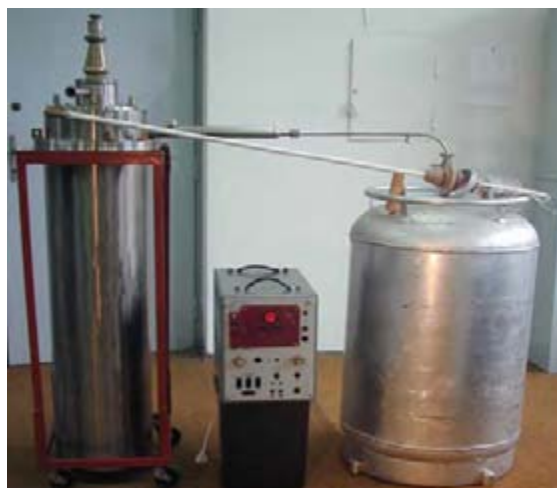
Rys. 3. Widok ogólny stanowiska rezystywnego nadprzewodnikowego ogranicznika prądowego z widocznym położonym uchwytem zawierającym element nadprzewodnikowy.
