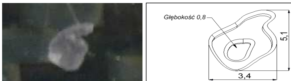
Rys. 4.80. Wada produkcyjna na powierzchni kompozytu CFRP
