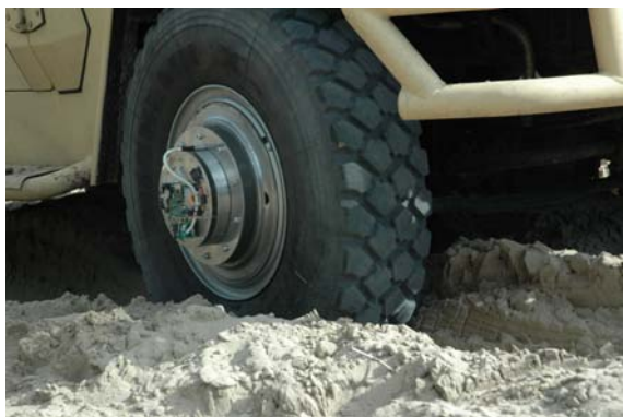
Rys. 5.16. Dynamometr do pomiaru sił i momentów na kole zainstalowany na pojeździe badawczym Dzik MED.
