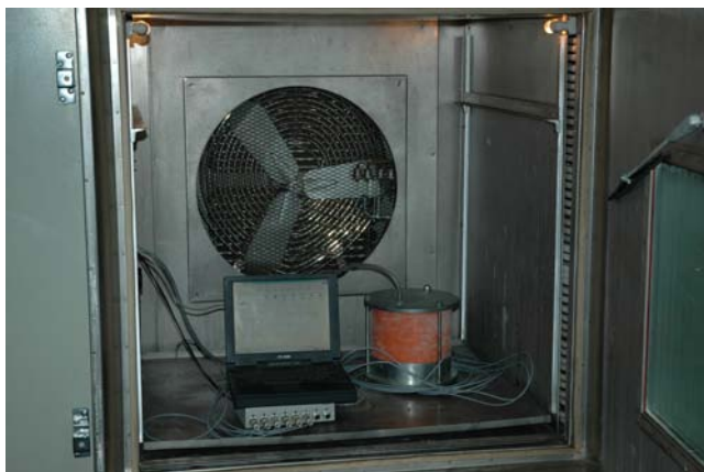
Rys. 2.9. Testy aparatury w komorze niskich temperatur
