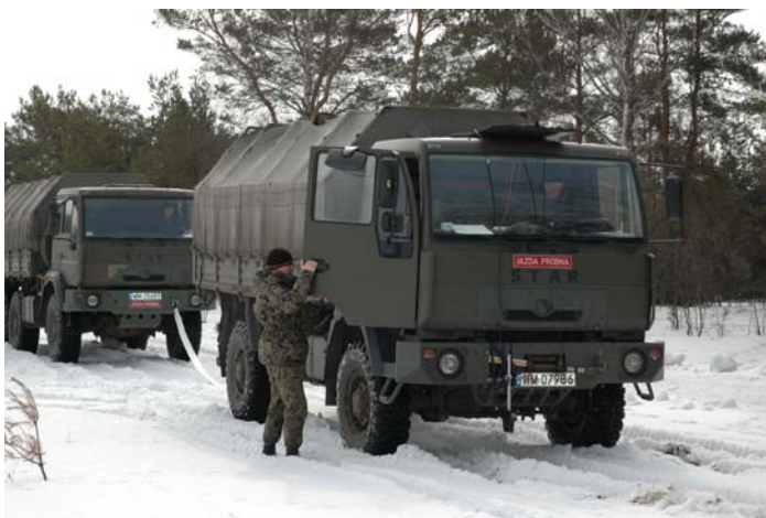
Rys. 6.9. Obiekt badań: samochód STAR 944, pod którego obciążeniem wyznaczano stan naprężeń w śniegu
