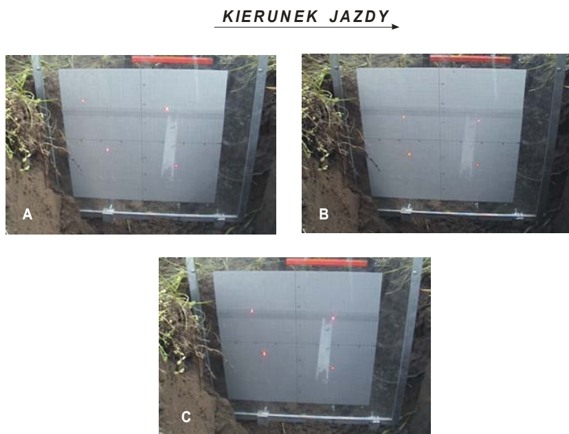
Rys. 3.18. Przykładowe widoki ekranu podczas rejestracji odkształceń podłoża powodowanych obciążeniem pojazdu. Opis w tekście.
