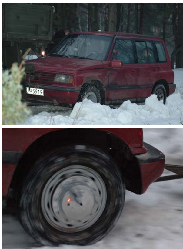
Rys. 6.12. Pojazd badawczy podczas jazdy testowej na podłożu śnieżnym oraz koło dynamometryczne do pomiaru siły bocznej
