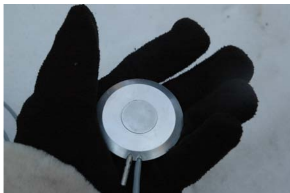
Rys. 2.11. Niskoprofilowy czujnik naporu do badań śniegu
