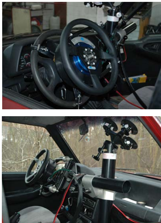
Rys. 2.25. Systemy wyposażenia pomiarowo-badawczego. Od góry: robot sterujący – siłownik na kierownicy, konstrukcja wsporcza, DGPS.
