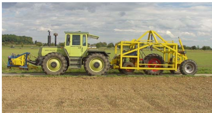
Rys. 4.1. Tester kołowy z Uniwersytetu Hohenheim (Ferhabbegovic, 2006)
