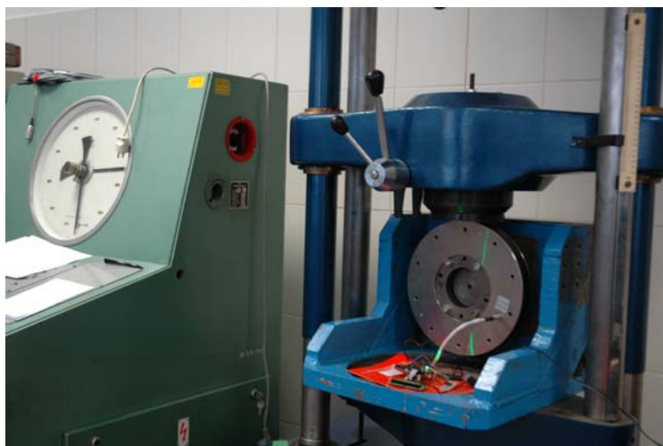
Rys. 2.19. Kalibracja dynamometru na maszynie wytrzymałościowej (ZEPWN, Marki)
