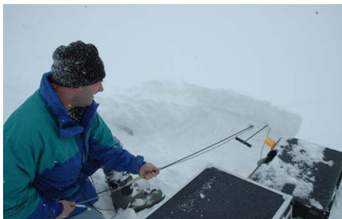
Rys. 6.2. Instalacja czujników w śniegu głębokim
