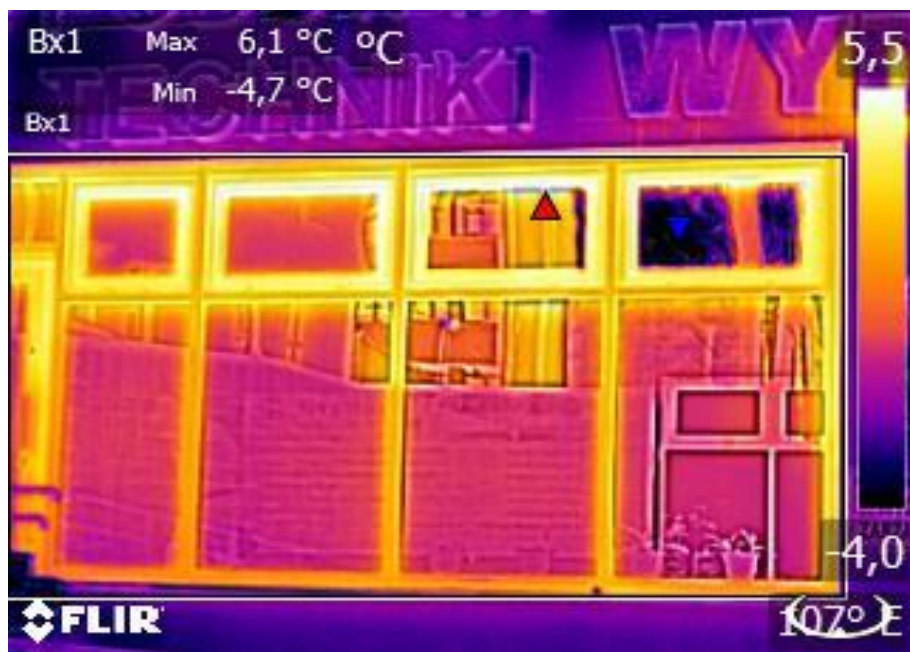
Rys. 3. Obraz termowizyjny z nałożonym obrazem cyfrowym w module MSX
