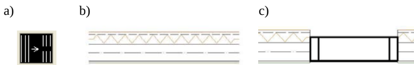
Rys. 2.18. Edycja multilinii: a) ikona opcji utnij wszystko; b) multilinia; c) multilinia po wycięciu i wstawieniu okna
