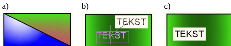
Rys 4.4. Przykłady zastosowania polecenia WYPEŁNIENIE: a) obiekty wypełnione gradientem jednokolorowym oraz dwukolorowym; b) przesuwanie napisu umieszczonego w wypełnieniu obiektu – zastosowano opcję Zespolone ; c) zmiana położenia napisu – wypełnienie dostosowuje się do nowego umiejscowienia napisu
