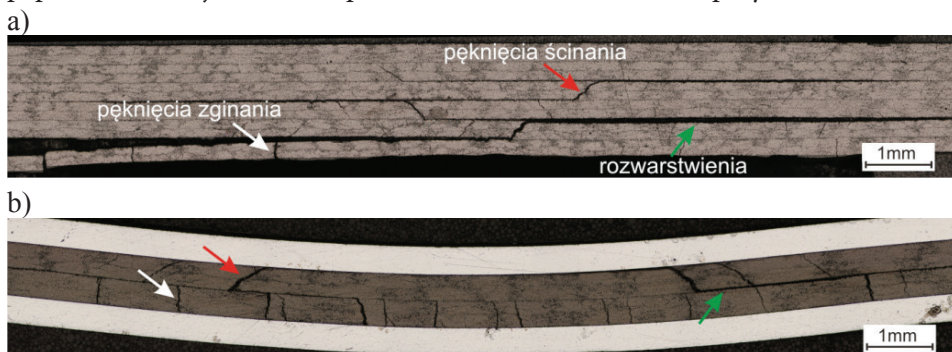
Rys. 13. Charakterystyczne formy zniszczenia laminatów poddanych obciążeniom dynamicznym: (a) kompozyt epoksydowo-węglowy (b) laminat metalowo-włóknisty: aluminium-kompozyt epoksydowo-węglowy [48]
