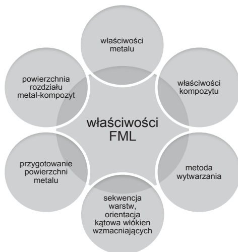
Rys. 2. Czynniki wpływające na właściwości laminatów metalowo-włóknistych
