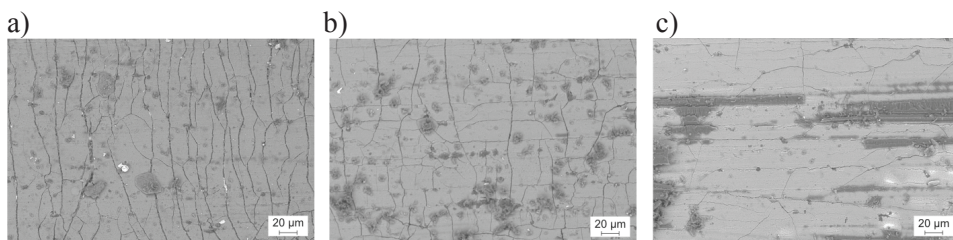
Rys. 67. Morfologia powierzchni warstwy tlenkowej z pęknięciami na dolnej powierzchni rozdzielu metal-kompozyt dla energii obciążenia dynamicznego 15 J; (a) strefa bezpośredniego obciążenia dynamicznego węglownikiem; (b) na granicy oddziaływania węglownika; (c) strefa poza oddziaływaniem węglownika
