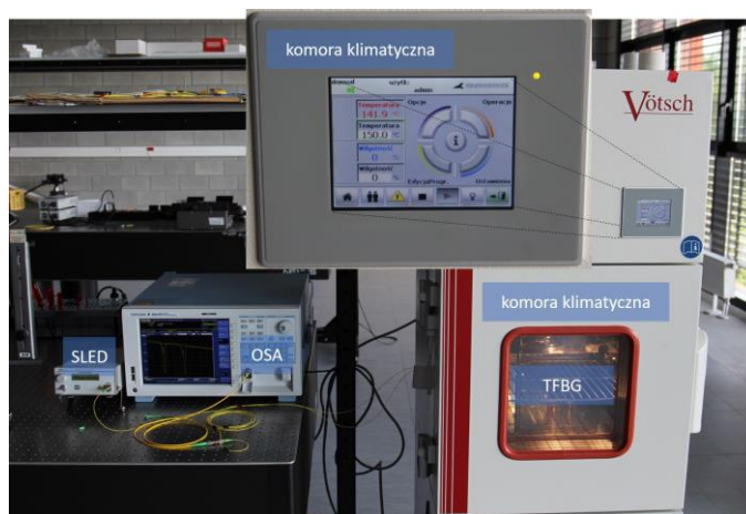
Rys. 6.1. Stanowisko laboratoryjne wykorzystywane przy pomiarach temperaturowych TFBG
