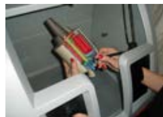
Oczyszczanie z proszku wydrukowanego modelu 3D (fot. Grzegorz Barański)
