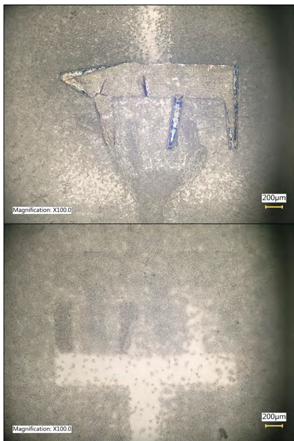
Ryc. 3.32. Uszkodzone elektrody kondensatorów niklowych z widocznymi komórkami po 67 h (24-godzinna stabilizacja warunków medium i 43-godzinna hodowla komórek)
