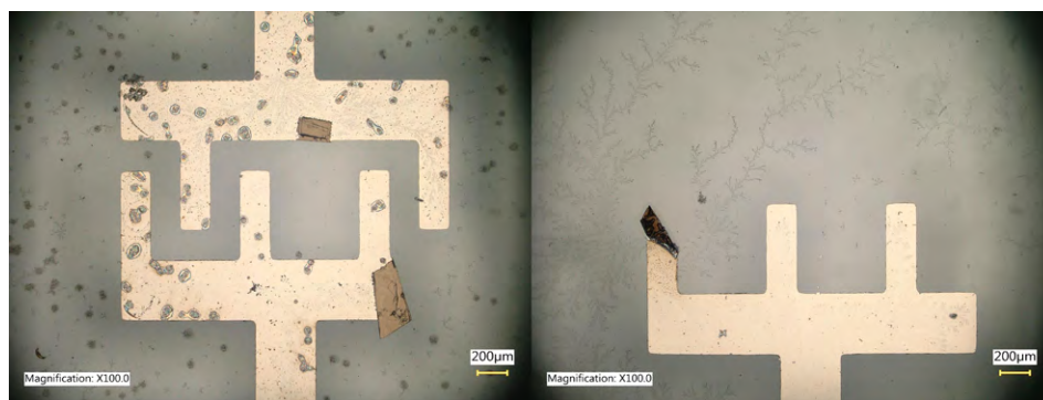
Ryc. 3.31. Uszkodzone elektrody kondensatorów niklowych bez komórek w naczyniu referencyjnym po 67 h
