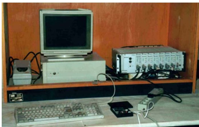
Rys. 6.2. Komputerowe stanowisko pomiarowe ze wzmacniaczem i przetwornikiem A/D firmy Ambex.
