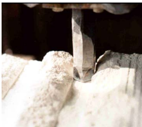
Rys. 6.12. Zarys bruzdy powstałej w wyniku skrawania nożem nr 2.
