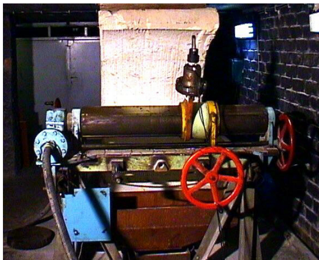
Rys. 6.6. Mechanizmy do zmiany podziałki i głębokości skrawania.
