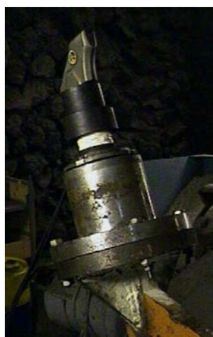
Rys. 6.7. Siłomierz tensometryczny używany do badań.
