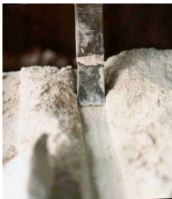
Rys. 6.10. Zarys bruzdy powstałej w wyniku skrawania wapienia nożem nr 1 (o płaskiej powierzchni natarcia i przyłożenia).
