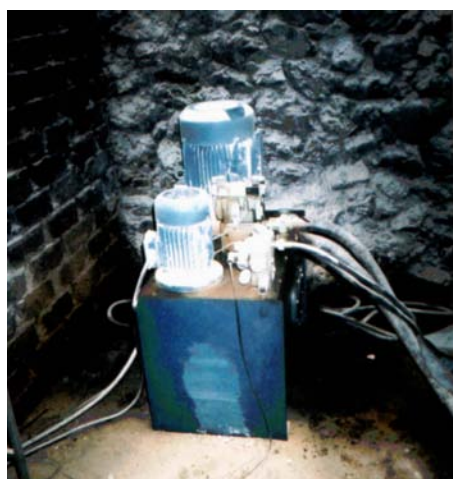
Rys. 6.5. Moduł zasilający silnik hydrauliczny stanowiska badawczego.
