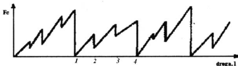
Rys. 2.17. Wyidealizowany przebieg czasowy siły skrawania F_c w funkcji drogi l dla skał [59].
