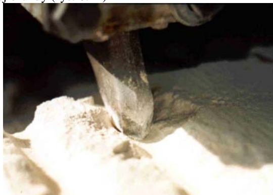
Rys. 6.14. Kształt bruzdy powstałej po przejściu noża nr 3.
