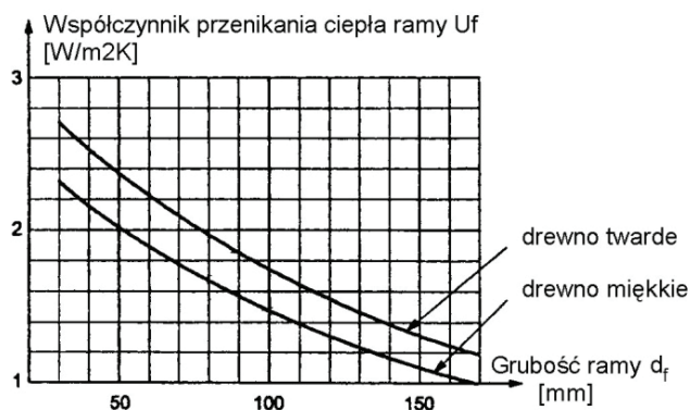
Rys. 2. Izolacyjność termiczna profili z drewna twardego i miękkiego, wg [3]
