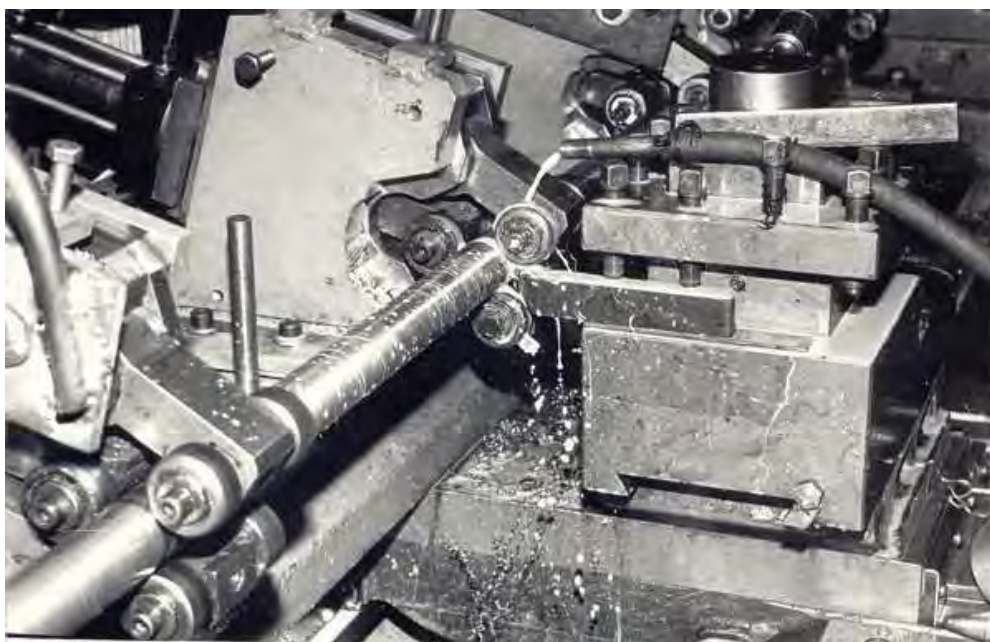
Rys. 6.7. PSH w procesie obróbki wału o małej sztywności
