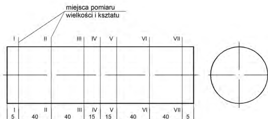
Rys.5.10. Przekroje półfabrykatu, w których dokonano pomiarów
