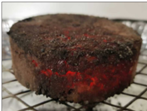
Fot. 11. Żarzący się sprasowany miął węglowy przy użyciu Teracryl® C
