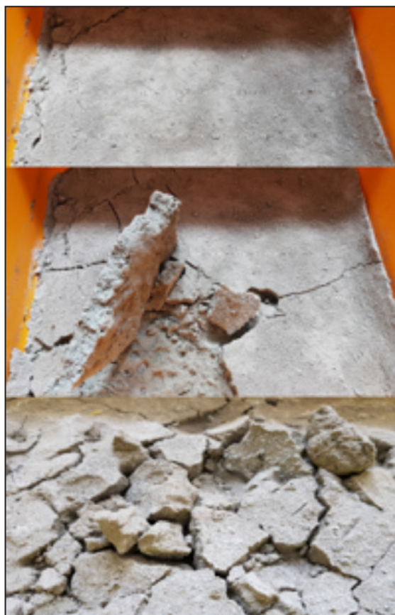
Fot. 7. Sklejony piasek przy użyciu preparatu Teracryl® T
