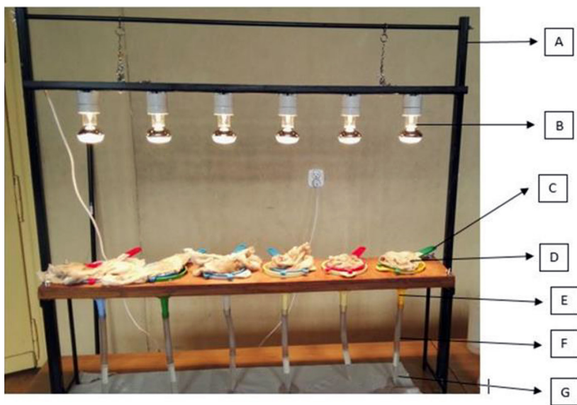
Rys. 3. Aparat Tullgrena użyty do badań (A – metalowy stelaż; B – źródło ciepła (żarówka grzejna o mocy 60W); C – próba gleby; D – gaza jałowa 17 nitkowa; E – lejek; F – gumowy przewód; G – falkon z wodą o pojemności 15 ml) (fot. Ł. Radosz)
