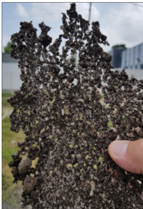
Fot. 8. Zagregowana ziemia ogrodowa przy użyciu Teracryl® A
