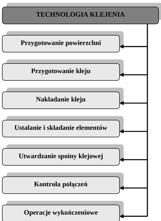
Rys. 2.1. Operacje procesu technologicznego klejenia
