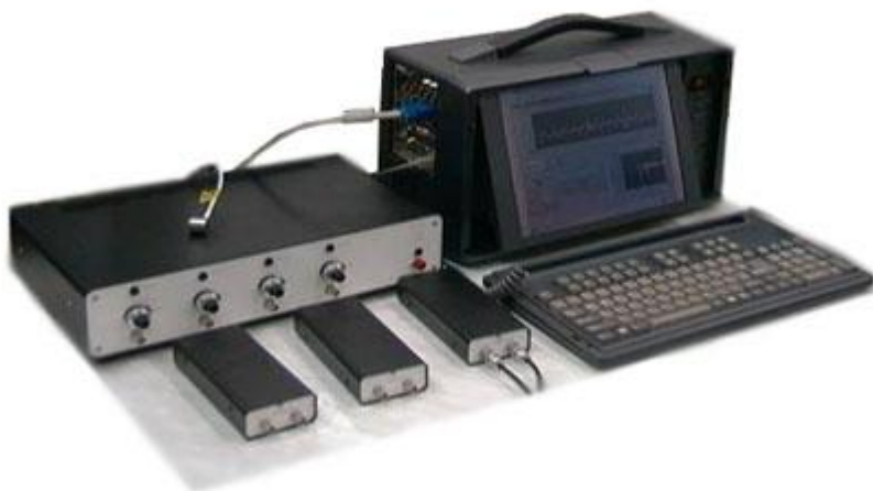
Rys. 8.6. Przenośny system do detekcji, identyfikacji i lokalizacji źródeł wyladowań niezupełnych metodą emisji akustycznej [111]
