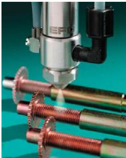
Rys. 5.40. Metoda nanoszenia kleju poprzez rozpylenie [76]
