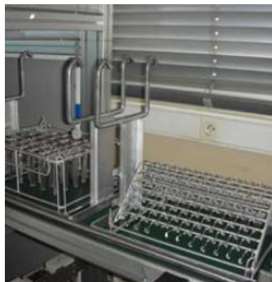
Rys. 4.1. Przykład: a) myjki wannowej ultradźwiękowej PS-80A [81], b) linii ultradźwiękowej [86]
