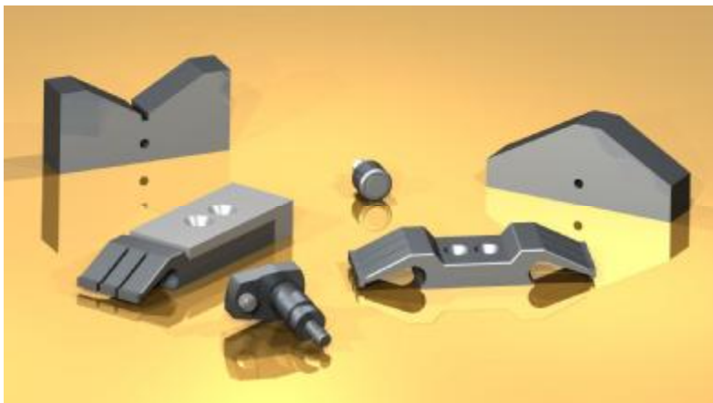
Rys. 6.8. Oprzyrządowanie wykorzystywane do ustalenia i składania połączeń klejowych [7]
