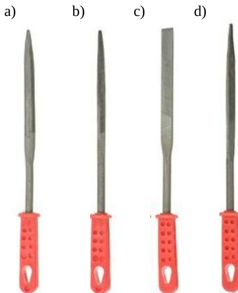
Rys. 9.3. Przykład pilników: a) półokrągły, b) kwadratowy, c) płaski, d) trójkątny [79]
