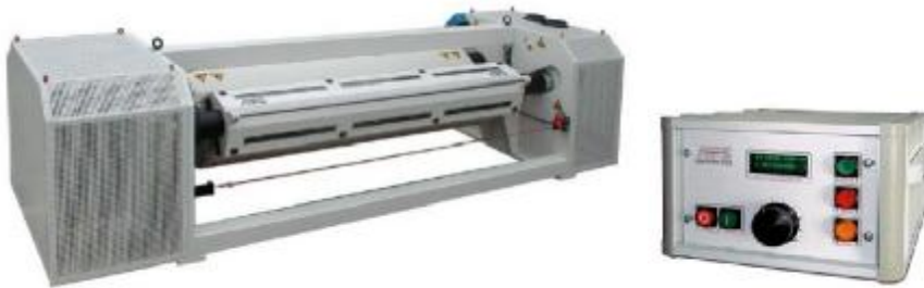
Rys. 4.12. Urządzenie do koronowania (skototron) AFS do folii [132]
